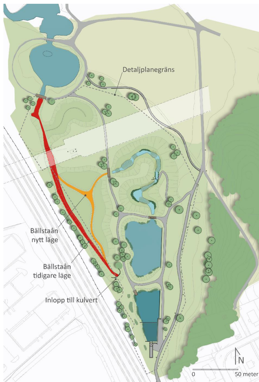
Illustrationsplan med Bällstaåns befintliga sträckning markerat med rött och dess föreslagna sträckning markerat med orange. Detaljplanegräns är markerad med grå streckad linje. (Ramboll)
