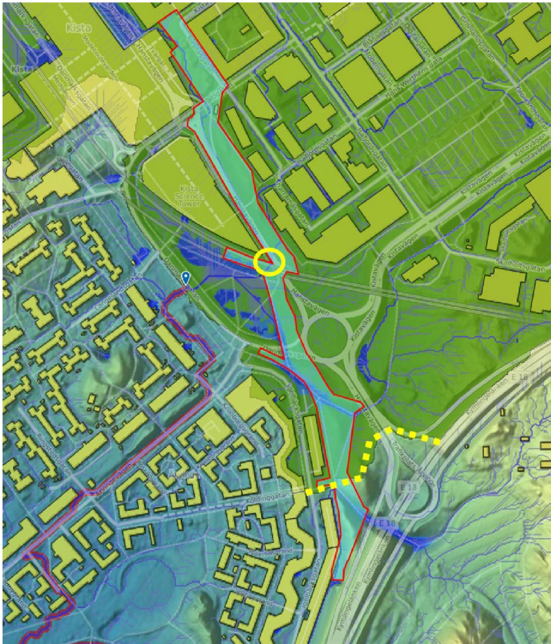
Figur 4 Figuren visar avrinningsvägar i området. Gul streckad linje indikerar högpunkt och gul ring lågpunkt på sträckan. Väster om markerad lågpunkt ser man ytor som riskerar att översvämmas vid skyfall.
