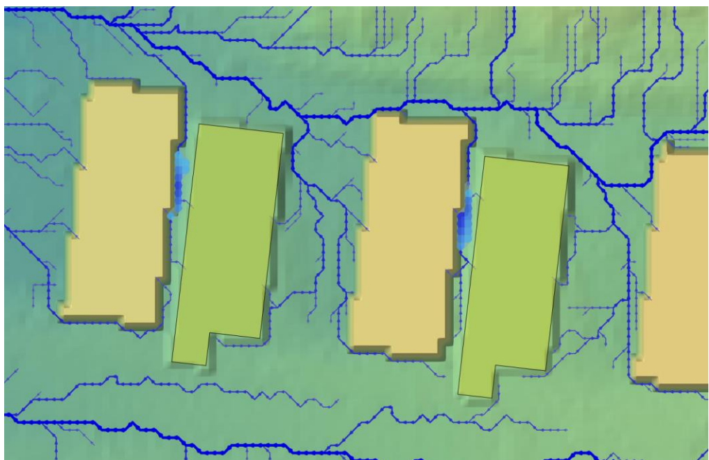
Figur 26 Skyfallssituationen påverkas inte negativt vid eventuell markhöjning för parkeringsplatser och resulterar inte i stående vatten på grönyrtorna
