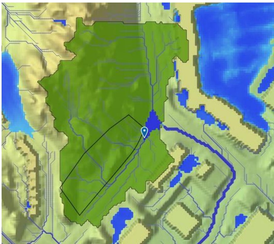
Figur 8. Delavrinningsområde (grönt) samt rinnvägar (lilablå linjer) för lågpunkten (markerad med knappnål) för planområde C-F (svart polygon). Observera att avrinningsområdet även gäller för delar som inte rinner in i planområdet.
