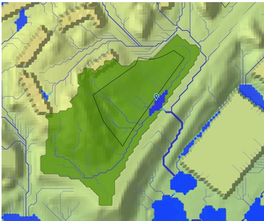
Figur 7. Delavrinningsområde (grönt) samt rinnvägar (lilablå linjer) för lågpunkten (markerad med knappnål) för planområde A-B (svart polygon). Observera att avrinningsområdet även gäller för delar som inte rinner in i planområdet.
