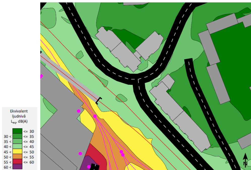
Ekvivalenta nivåer (dBA) för industribuller, 1,5 meter över mark.
