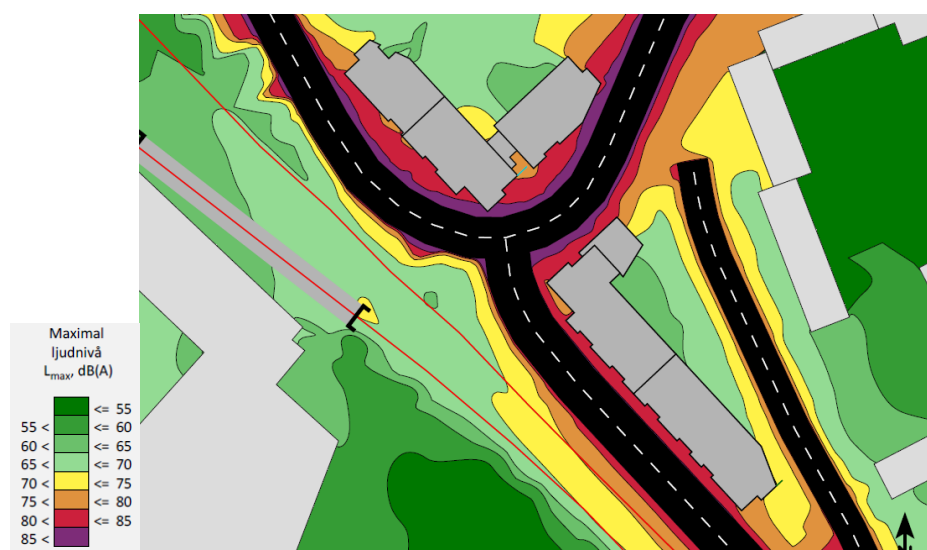
Maximal ljudnivå (dbA) för prognosår 2035 (väg), 1,5 meter över mark.
