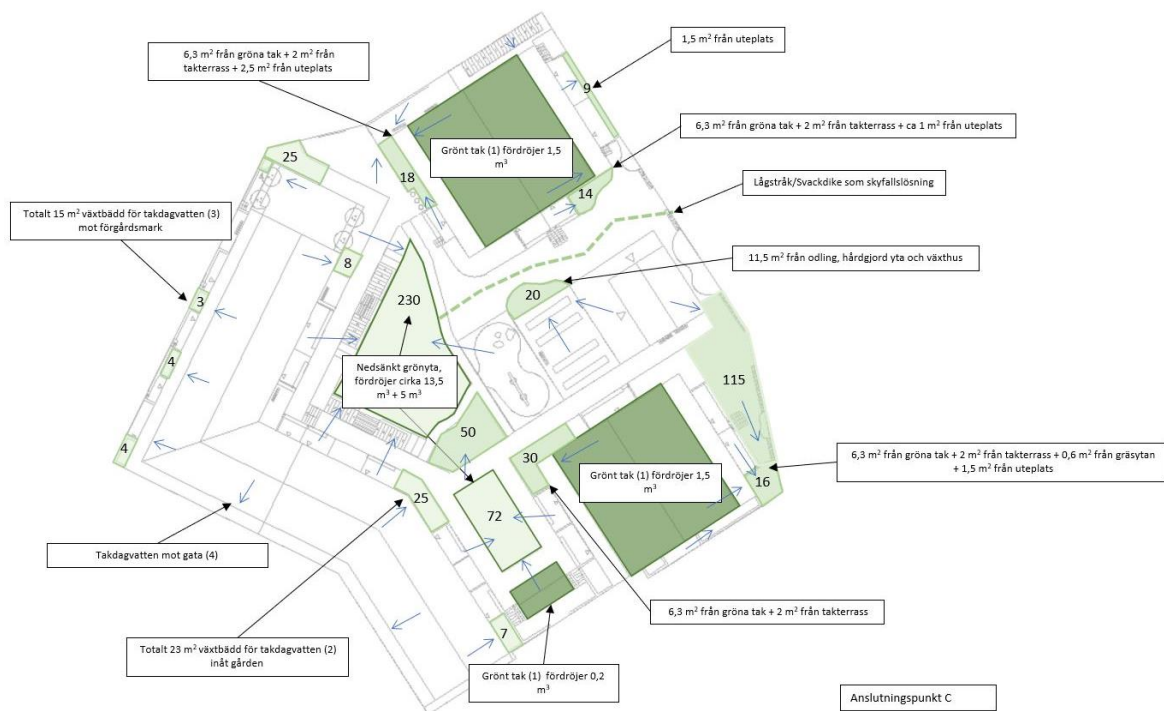
Figur 34. Förslag till dagvattenhantering i kvarter C.
