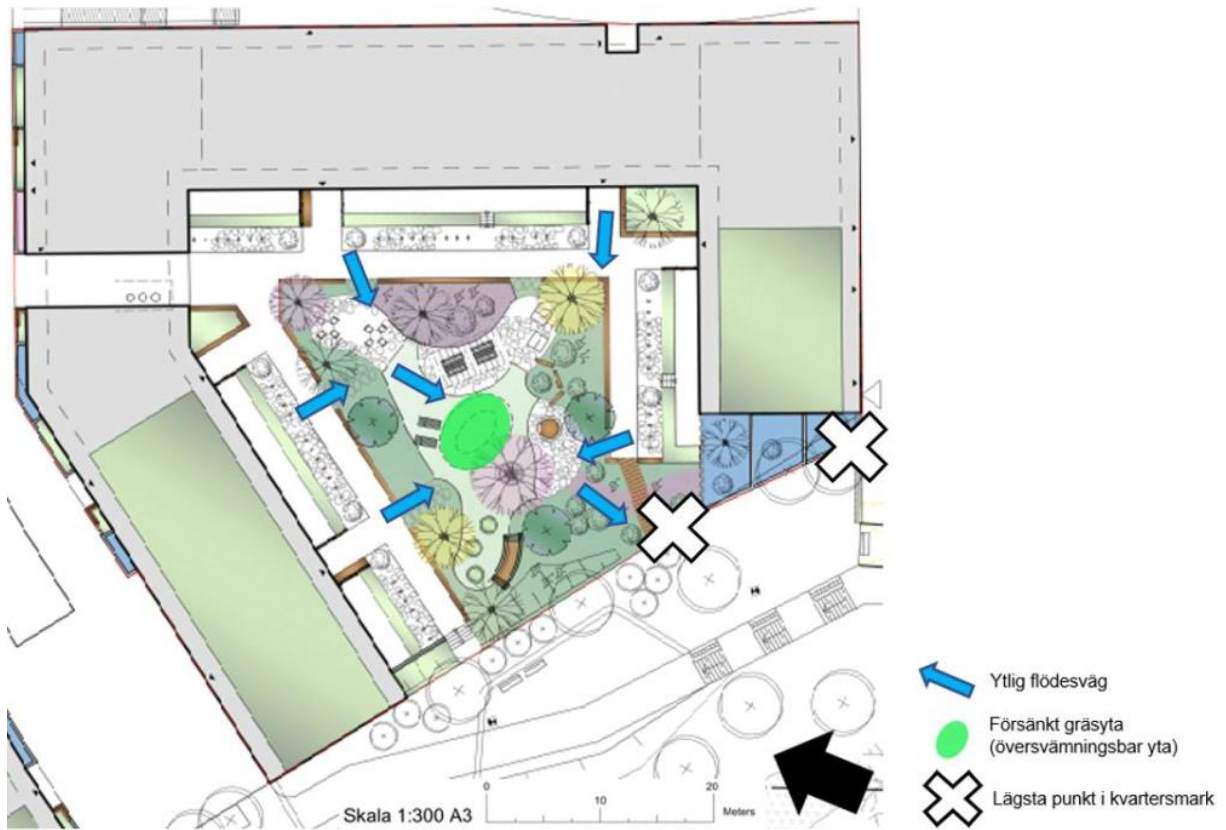
Figur 45. Förslag till skyfallshantering i kvarter E.
