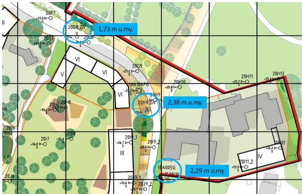
Figur 5. Provtagningsplatser för grundvattenmätning samt uppmätt vattennivå uttryckt i meter under marknivån (m u.my.).
