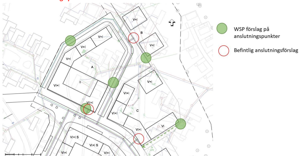
Figur 29. Förslag på anslutningspunkter för dagvatten i kvarter A, B och C.
