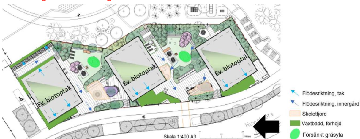
Figur 40. Förslag till dagvattenhantering i kvarter D.
