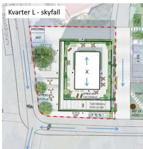
Figur 59. Föreslagen skyfallshantering i kvarter L. Flödesriktningar markerade med blå pilar.
