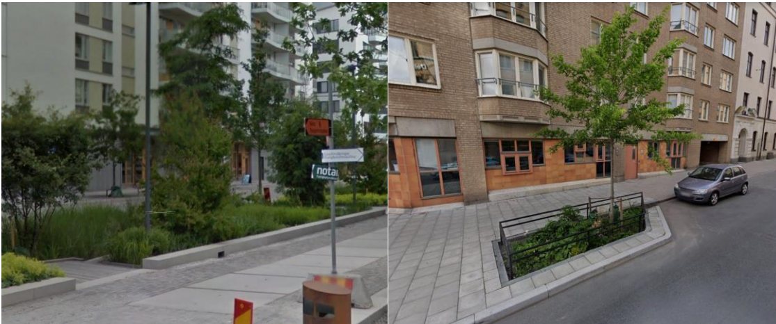
Figur 14. Lövängsvägen i Norra Djugårdssten, nedsänkt och varierat grönt stråk i modern stadsmiljö. Rehnsgatan, växtbädd med släpp i kantsten i gatan för effektiv dagvattenhantering, från Google Streetview .
