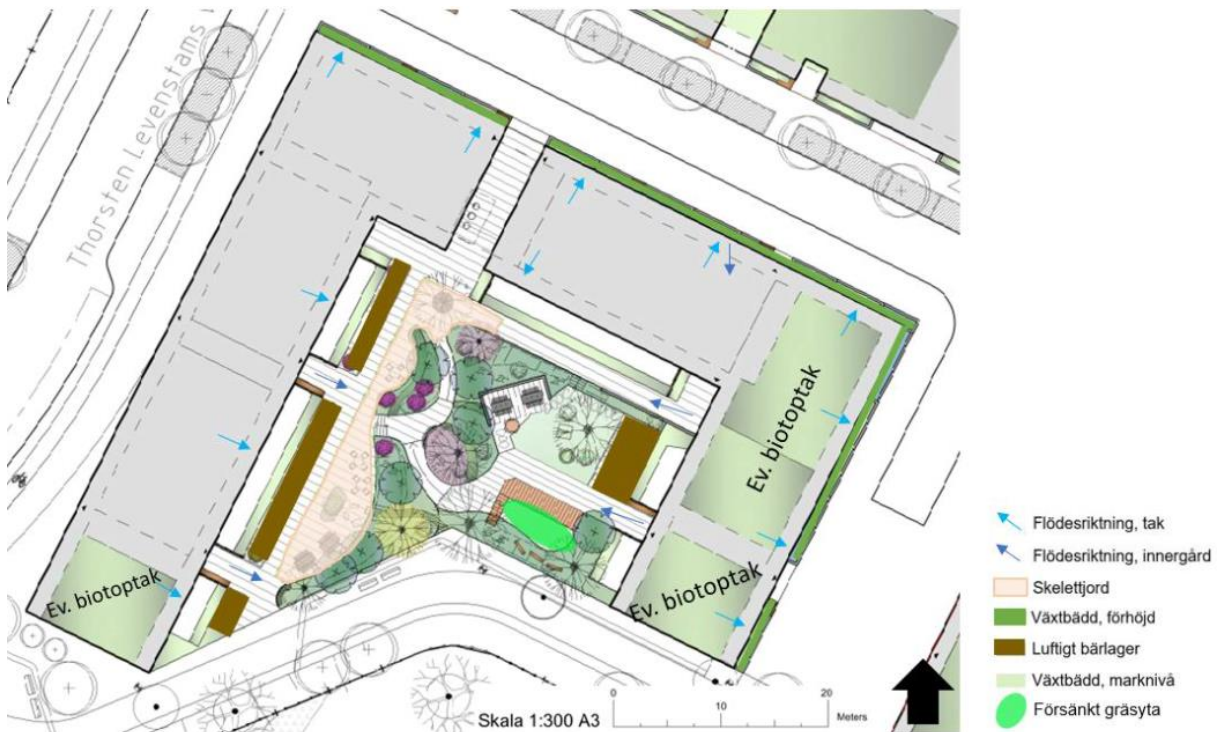
Figur 42. Förslag till dagvattenhantering i kvarter F.
