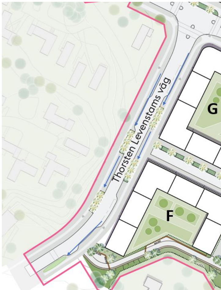
Figur 19. Dagvattenhantering längs Thorsten Levenstams väg
