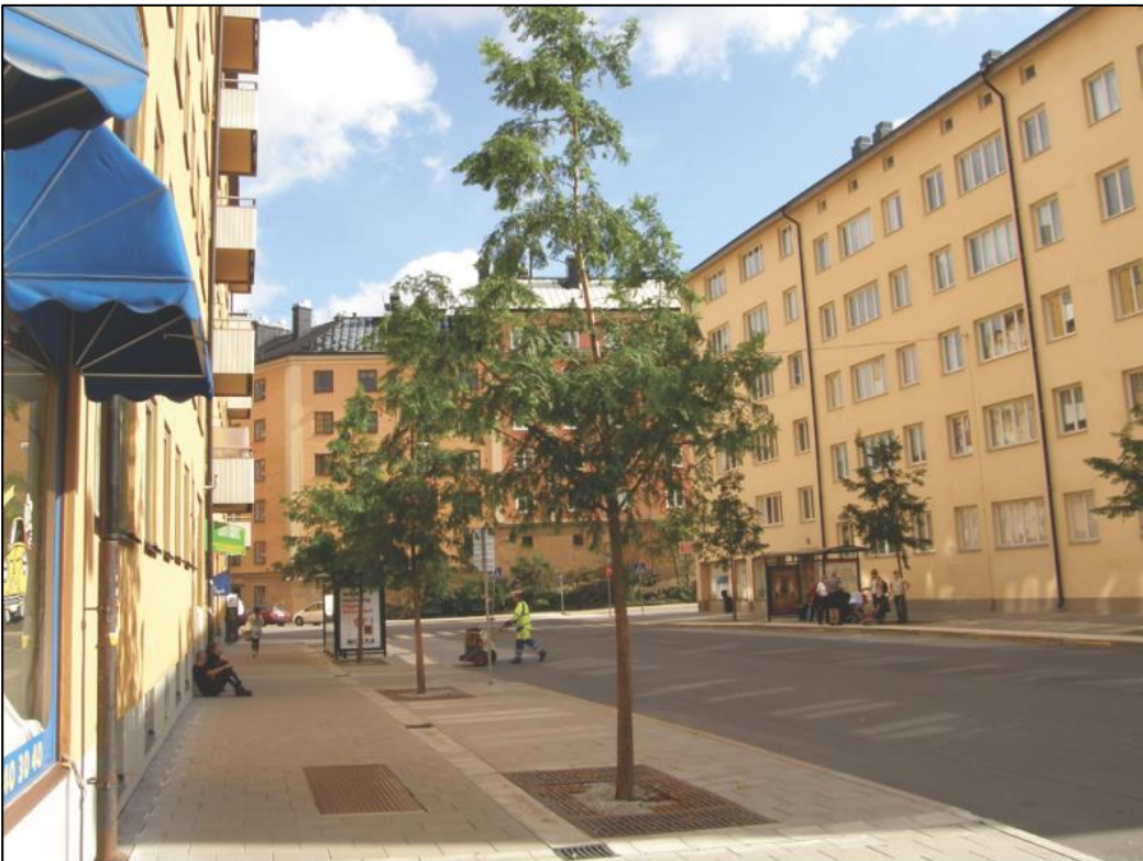
Figur 13. Exempel på trädrad i skelettjord. Dagvatten avleds till skelettjord via dagvattenbrunnar/ luftningsbrunnar.
