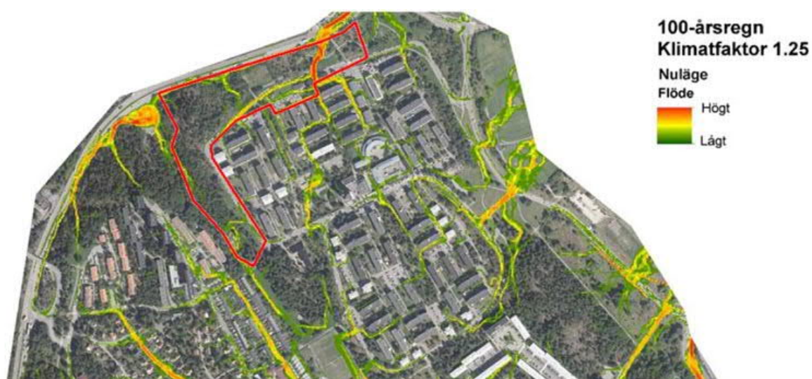
Figur 13. Flödesvägar vid 100-årsregn med klimatfaktor 1,25 och varaktighet 3 h vid befintliga förhållanden (Sweco, 2019). Utredningsområdet markerad med röd polygon.
