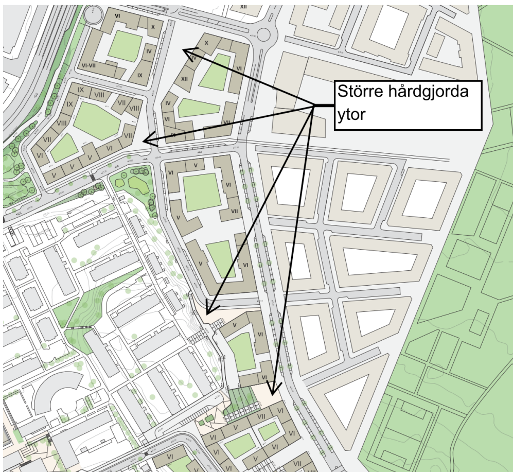
Figur 18. Exempel på hårdgjorda ytor inom planen där ytterligare fördröjnings och reningsåtgärder kan behövas.
