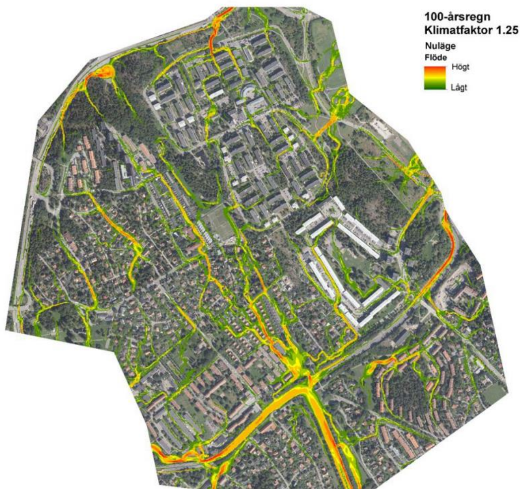
Figur 6. Flödesvägar vid 100-årsregn med klimatfaktor 1,25 och varaktighet 3 h vid befintliga förhållanden (Sweco, 2019)
