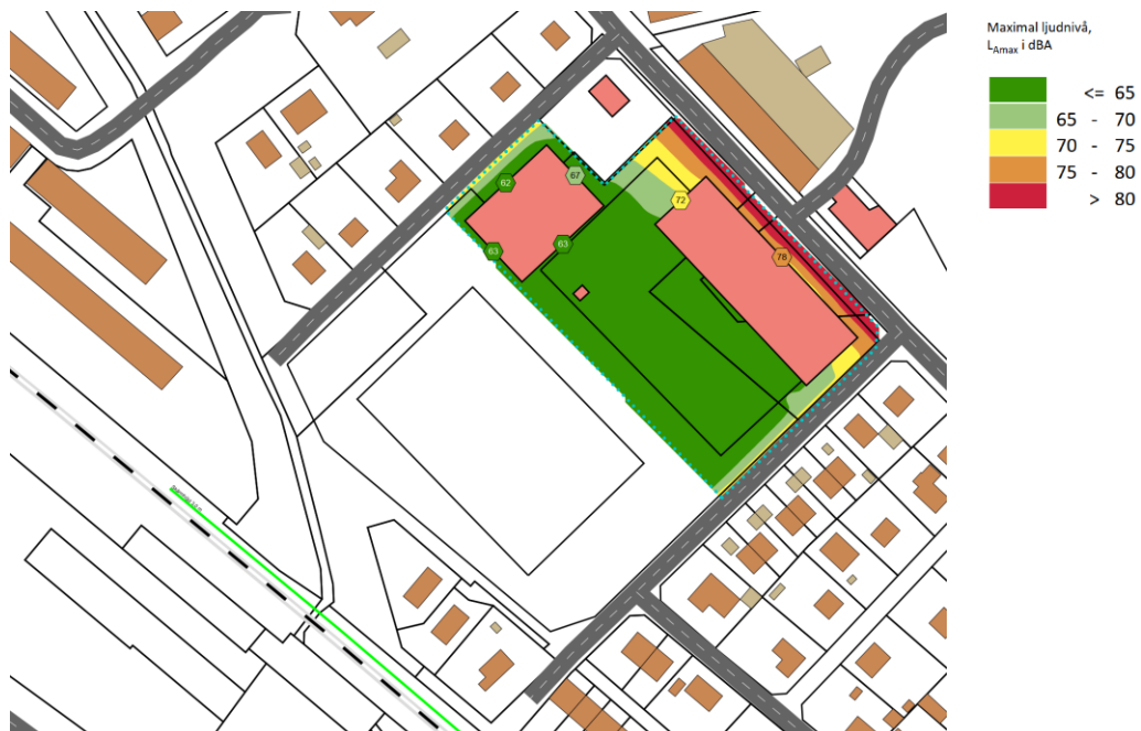
Figur 4. Maximal ljudnivå från väg- och spårtrafik på skolgård samt vid fasad. Hänsyn har tagits till 3 m hög bullerskärm vid spåret (ljusgrönt streck) samt ny bebyggelse i Bromstensstaden
