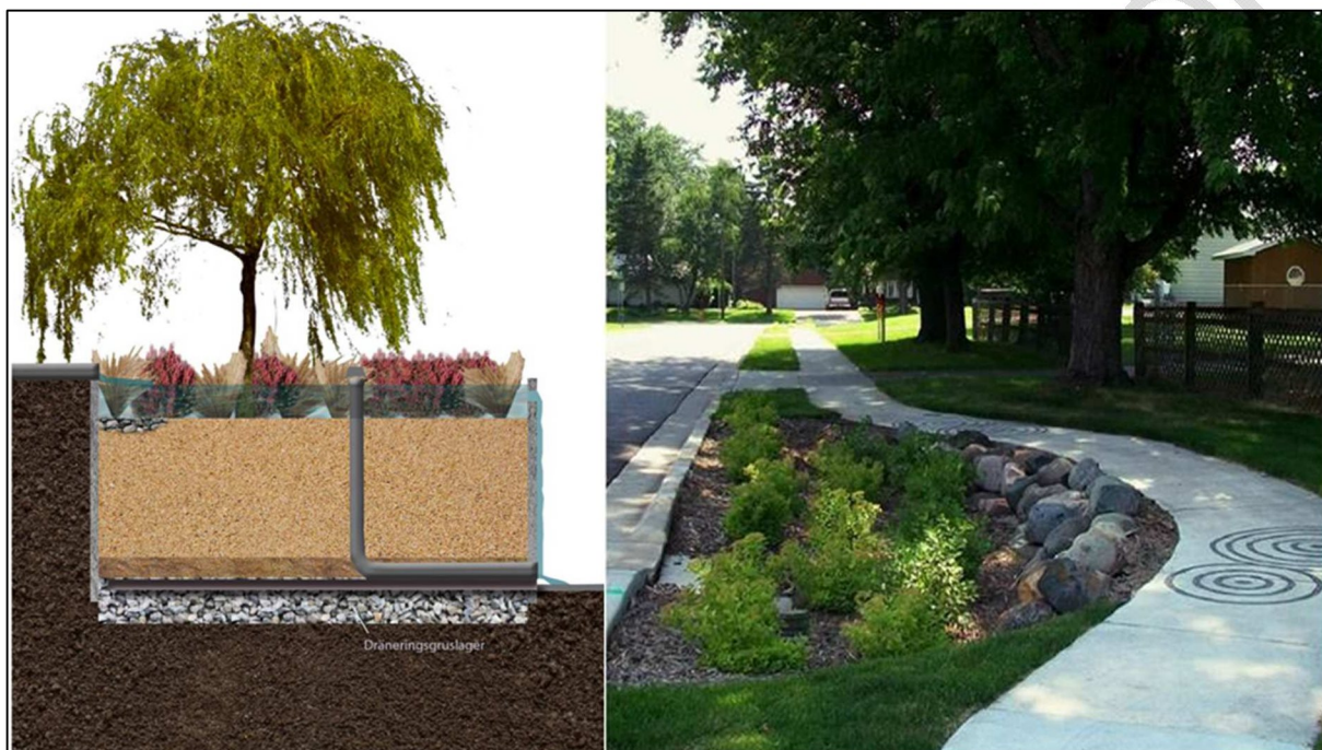
Figur 6-11. Illustration av hur en regnbädd kan byggas upp (Illustration Åsa Wellander och foto från City of Maplewood).
