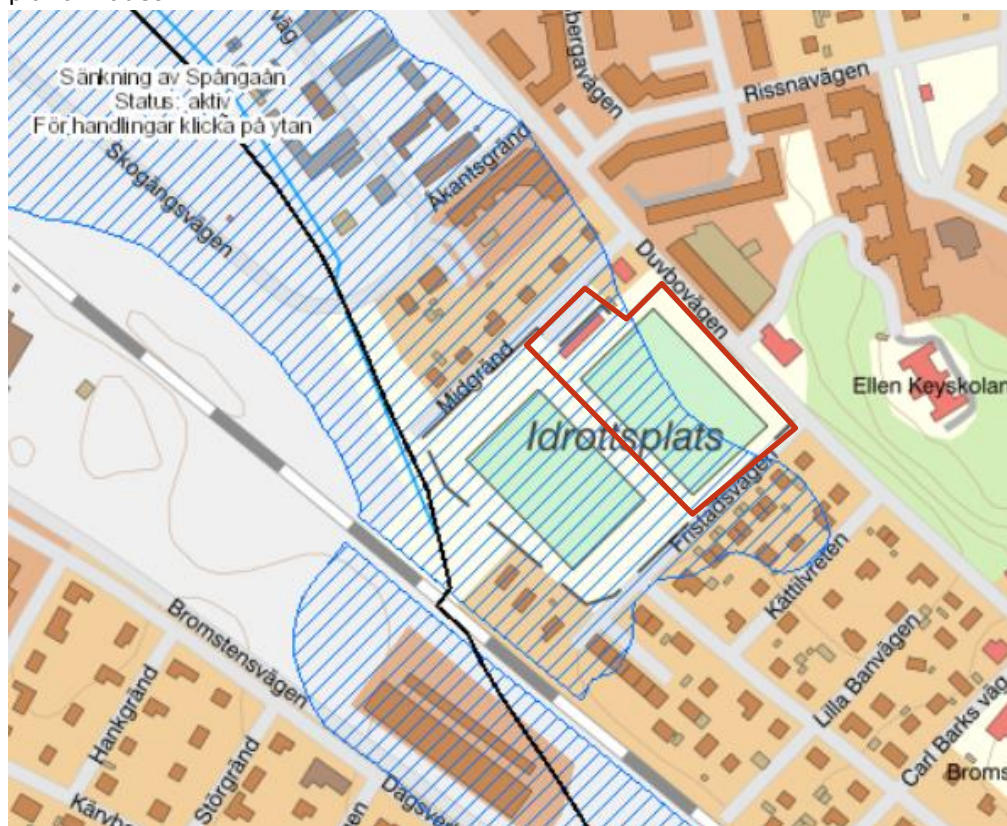
Figur 5. Markavvattningsföretaget (Spångaån AB 6 0201) visas med svart linje. Markavvattningsföretagets båtnadsområde visas med blå skraffering. Planområdet är ungefärligt utmarkerat med röd linje. Karta från Länsstyrelsen, 2021.
