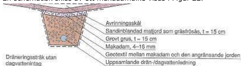
Figur 22. Schematisk skiss makadamdike, från Svenskt vatten (2016).
