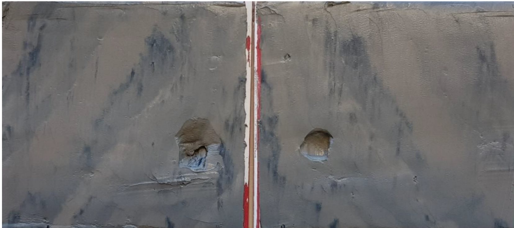
Figur 7 Borrpunkten, 21B05, 10,0 m, Jordprovet i nedre delen av mellanhylsan delad longitudinellt provhylsan med id Bjerking S 521.
