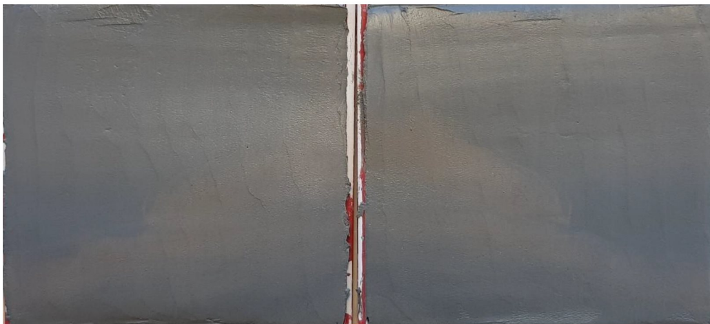
Figur 3 Borrpunkten, 21B02, 12,0 m, Jordprovet i nedre delen av mellanhylsan delad longitudinellt provhylsan med id Bjerking 1485.
