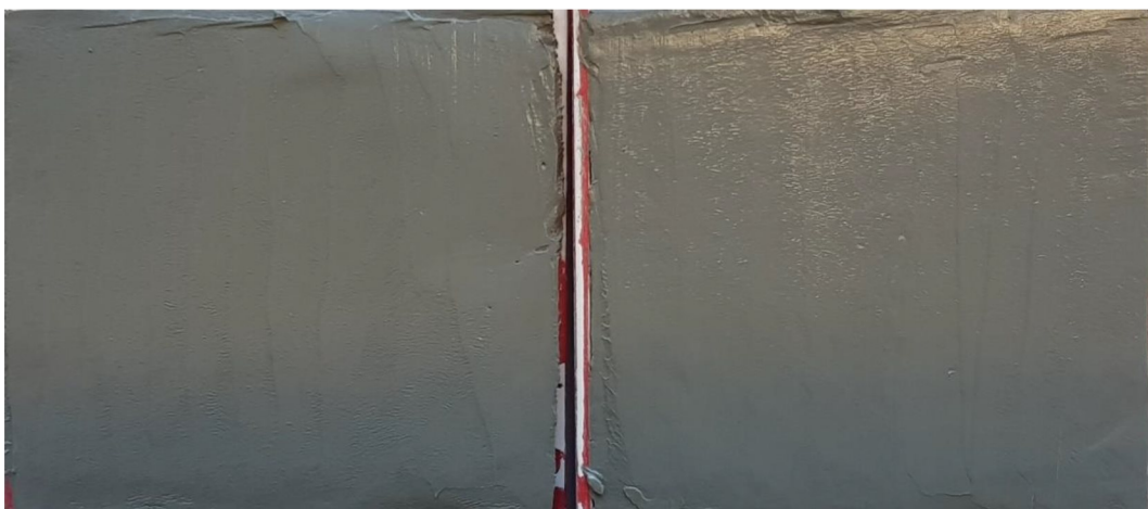
Figur 6 Borrpunkten, 21B05, 6,0 m, Jordprovet i nedre delen av mellanhylsan delad longitudinellt provhylsan med id Bjerking 1035.
