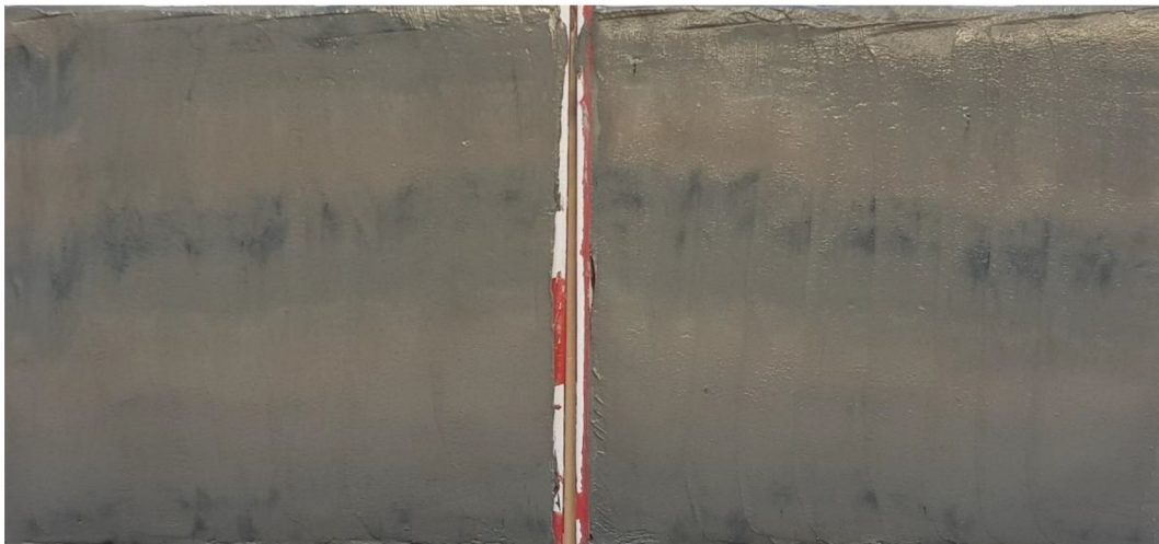
Figur 11 Borrpunkten, 21B08, 8,0 m, Jordprovet i nedre delen av mellanhylsan delad longitudinellt provhylsan med id Bjerking 1458.
