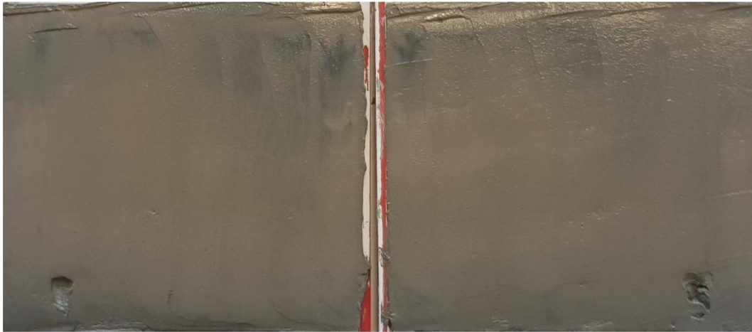
Figur 10 Borrpunkten, 21B08, 5,0 m, Jordprovet i nedre delen av mellanhylsan delad longitudinellt provhylsan med id Bjerking 1574.
