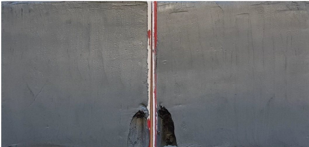
Figur 8 Borrpunkten, 21B05, 14,0 m, Jordprovet i nedre delen av mellanhylsan delad longitudinellt provhylsan med id Bjerking 1005.
