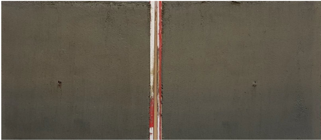
Figur 1 Borrpunkten, 21B02, 2,5 m, Jordprovet i nedre delen av mellanhylsan delad longitudinellt provhylsan med id Bjerking 1029.
