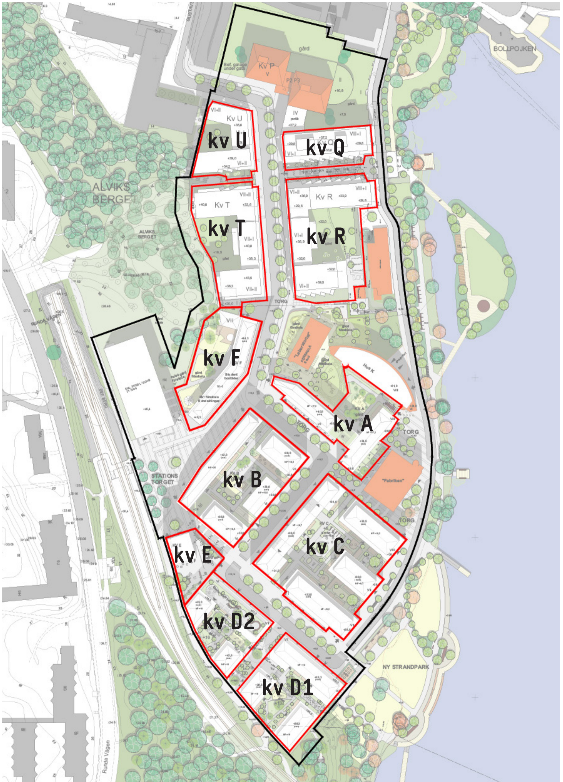
Situationsplan för Alviks strand med avgränsning för Tomtexploatering i rött och Kvartersexploatering i svart.
