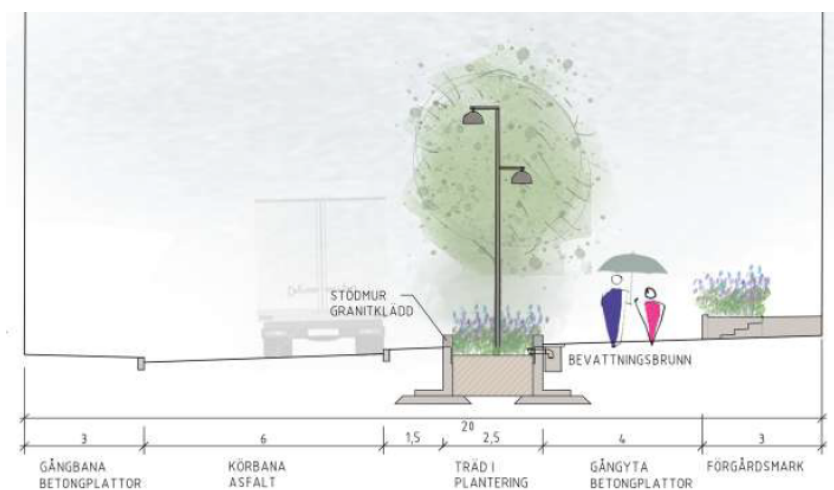
Gatusektion för övre och nedre allén på huvudgatan. (Ramboll)
