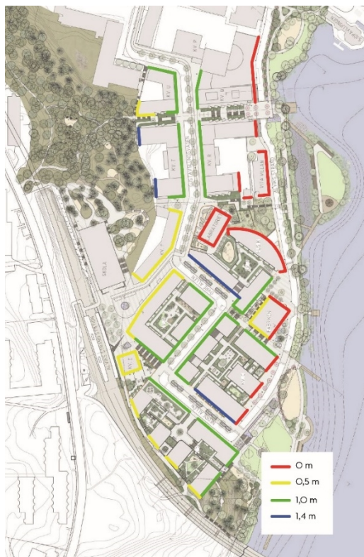
Balkongers högsta utkragning från fasadliv. (Sweco)
