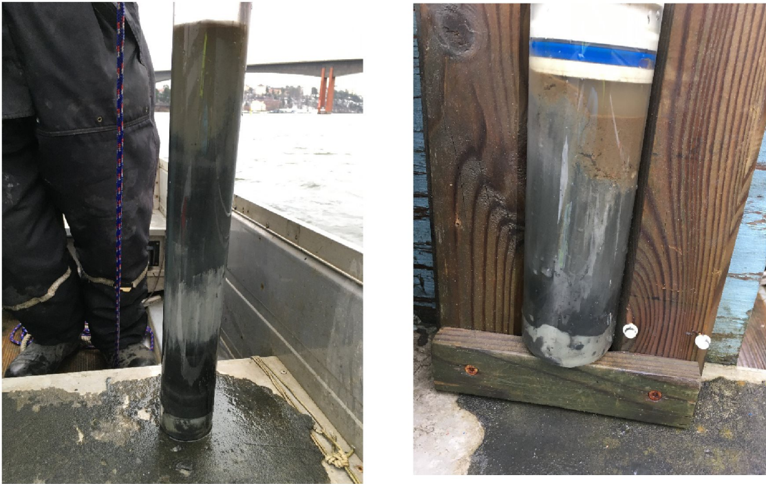
Figur 4-3 Till vänster syns sedimentkärna tagen på ett större djup, längre ut från strandlinjen. Till höger syns sedimentkärna tagen längre in mot strandlinjen där vattendjupet var grundare.
