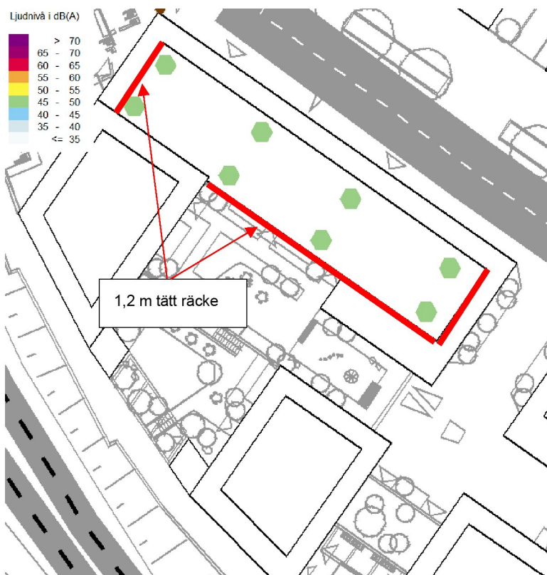
Figur 7. Förslag på utformning av täta räcken för att uppnå en bullerskyddad gemensam uteplats på terrassen i kvarter D2. Beräkningpunkterna visas som gröna hexagoner.
