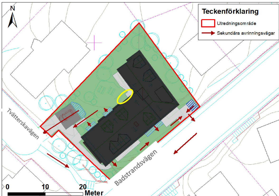
Figur 8-1. Förslag på sekundära avrinningsvägar från utredningsområdet. Lågpunktens som bör fyllas ut läge markerad med gul ring.
