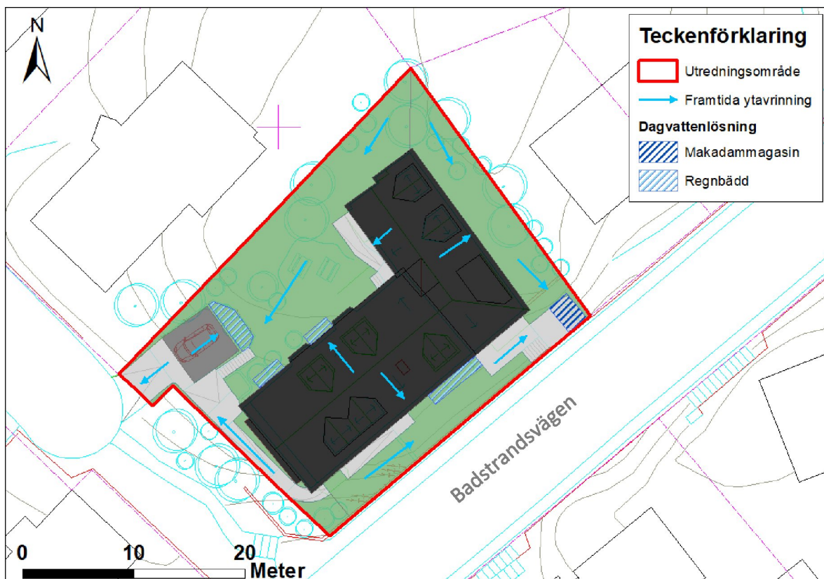
Figur 6-6. Förslag på hållbar dagvattenhantering inom utredningsområdet.
