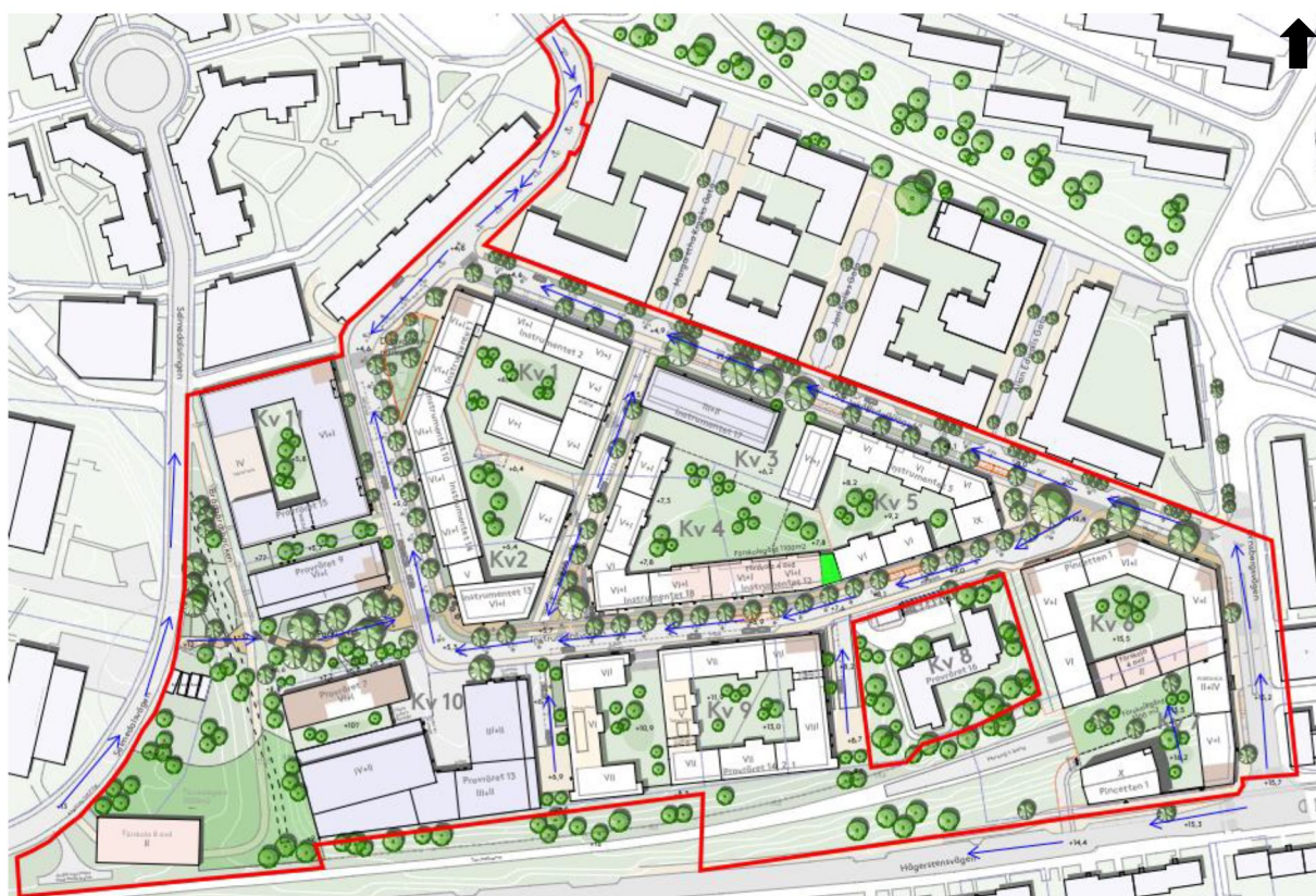
Figur 6. Blå pilar demonstrerar yttlig avrinning av vatten utifrån markhöjder vid planerad bebyggelse. Urklipp ur illustrationsplan (2022-01-24).
