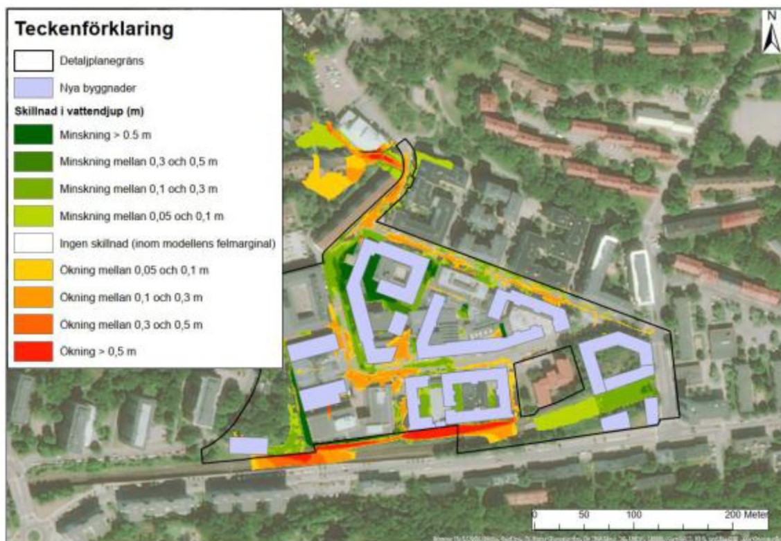
Figur 11. Skillnad i vattendjup mellan befintligt scenario och scenario efter omdaning, alternativ 2. Gröna ytor visar en minskning i vattendjup i jämförelse med nuläge och orange-röda färger visar en ökning (Tyréns, 2022-03-18).
