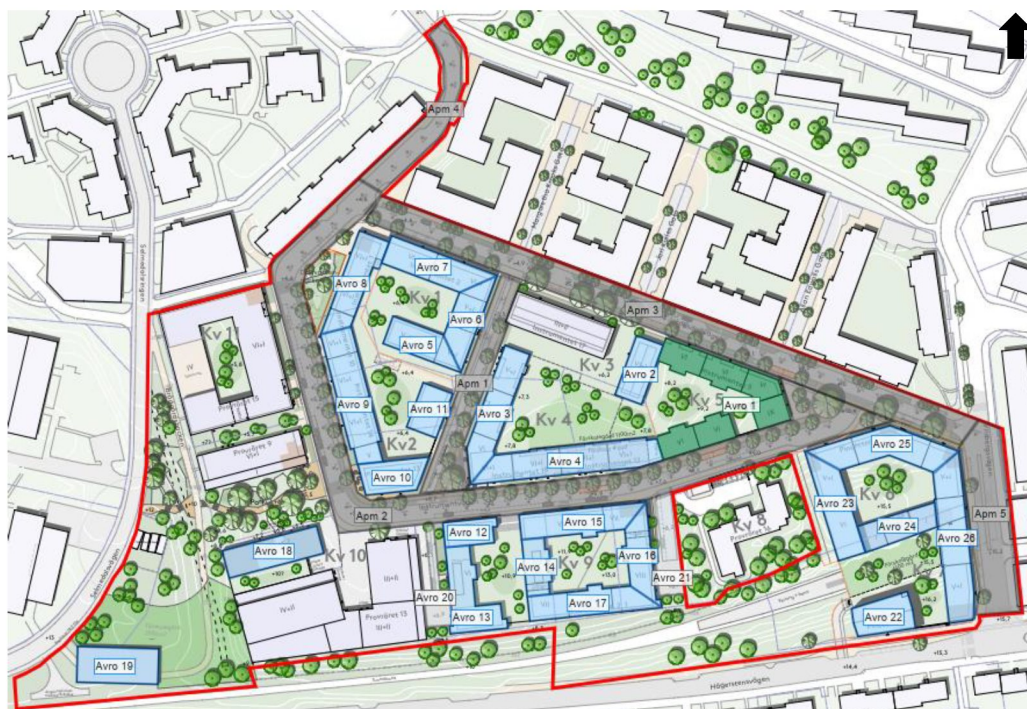
Figur 12. Urklipp ur situationsplan (AWL Arkitekter, 2022-01-24). Indelning av nytillkommen takyta, hårdgjord markyta samt allmän platsmark. Grönmarkerad takyta, avro 1, planeras anläggas med gröna tak.
