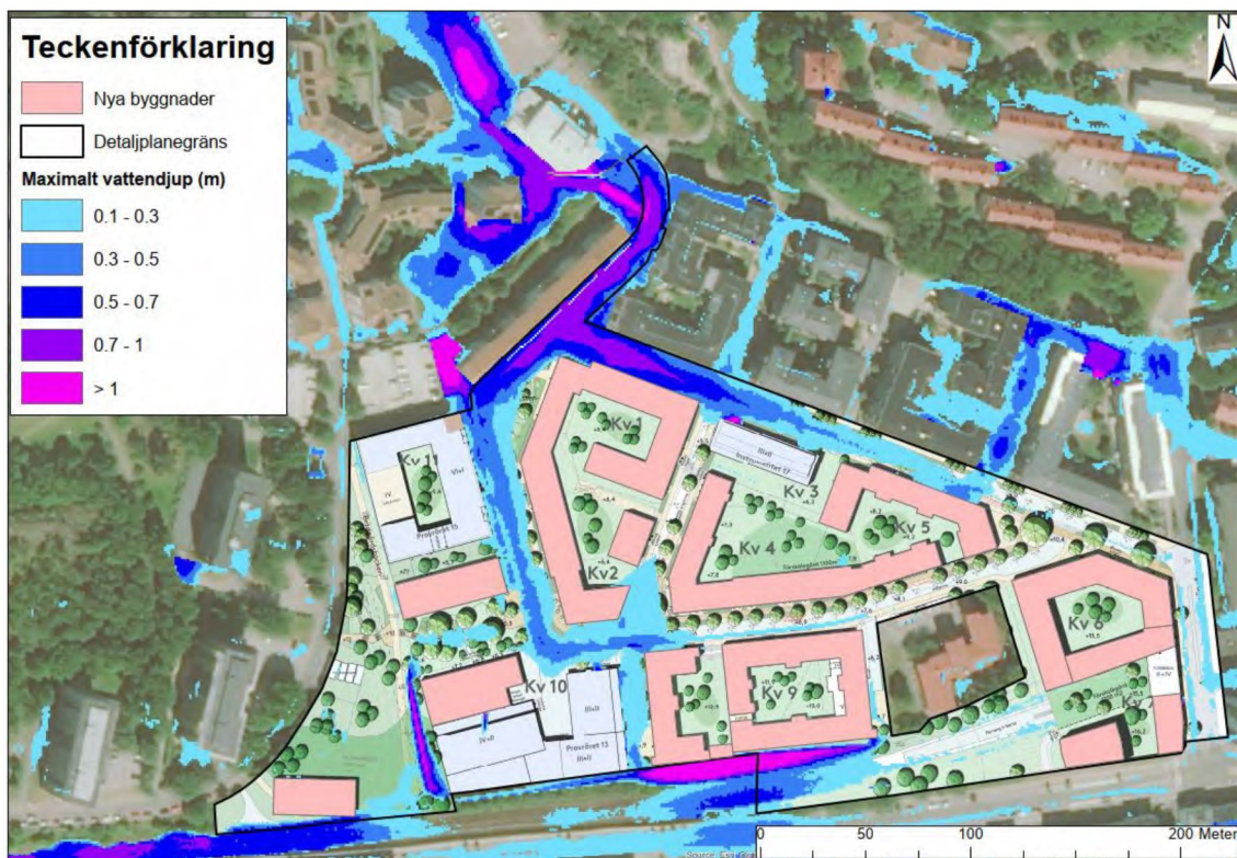
Figur 15. Maximalt vattendjup för scenario efter exploatering, alternativ 1.
