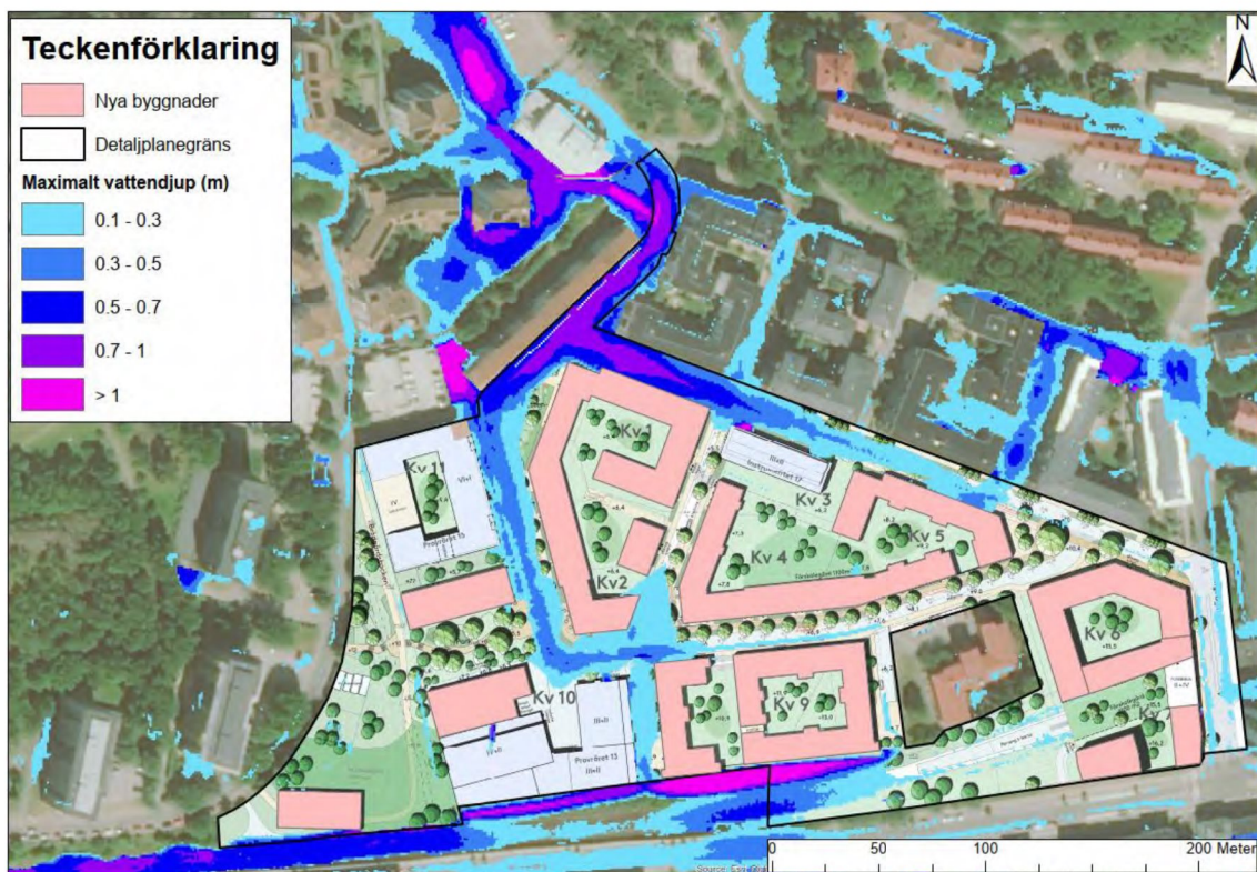
Figur 19. Maximalt vattendjup för scenario efter exploatering, alternativ 2.
