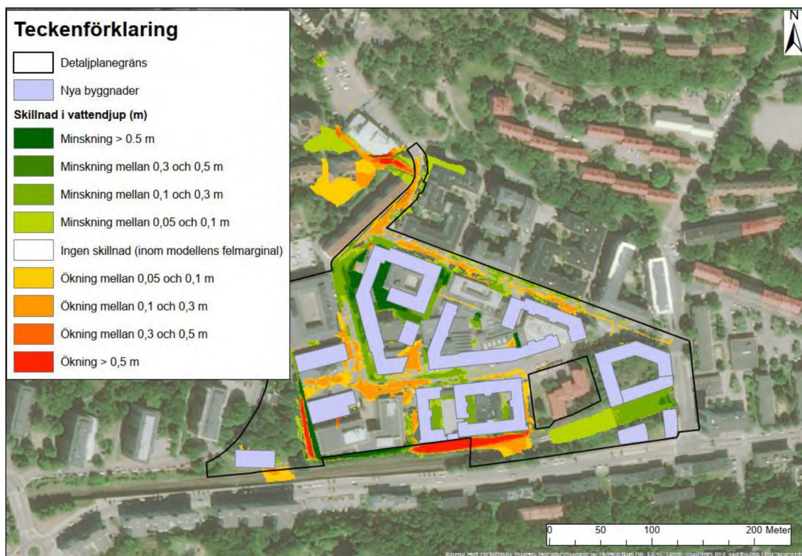
Figur 16. Skillnad i vattendjup mellan befintligt scenario och scenario efter exploatering, alternativ 1. Gröna ytor visar en minskning i vattendjup i jämförelse med nuläge och orangea-röda färger visar en ökning.
