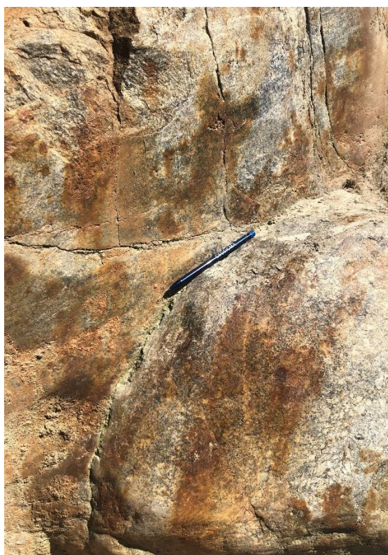
Figur 5-2. Längs Tappvägen: B. Bergslänt med tydlig rostutfällning på stor del av ytan. C. Kraftig rostutfällning på bergytan. D. Mindre rostutfällning på bergytan.
