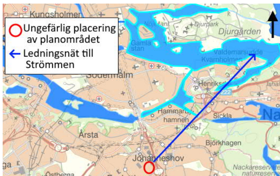
Figur 2. Recipienten Strömmen inringad med cyanfärg, planområdets placering (röd cirkel) samt dagvattenledningsnätet ut till Strömmen via Östberga dagvattentunnel. Källa: Vatteninformationssystem Sverige
