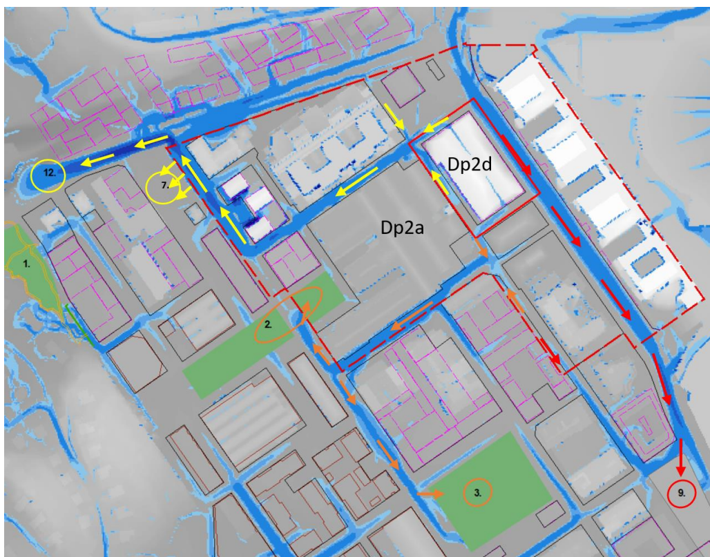
Figur 33 Hantering av skyfallsvattnet från Dp2a. Skyfallsvattnet hanteras i nr 2: Östra och Västra Fållan (utreds i detaljprojektering om mer vatten kan ledas dit inom Dp2), se orangea pilar samt i nr: 3 Centrala parken, nr:7, Slakthusplan se gula pilar (utreds hur mycket som kan tas omhand där inom Dp5), det vatten som inte ryms inom Slakthusplan och i östra respektive västra Fållan leds till befintligt spårområde och under överdäckningen inom Dp5b, nr: 12. och vattnet som rinner söderut längs Arenavägen och Rökerigatan röda pilar, hanteras på Evenemangstorget inom Dp4.
