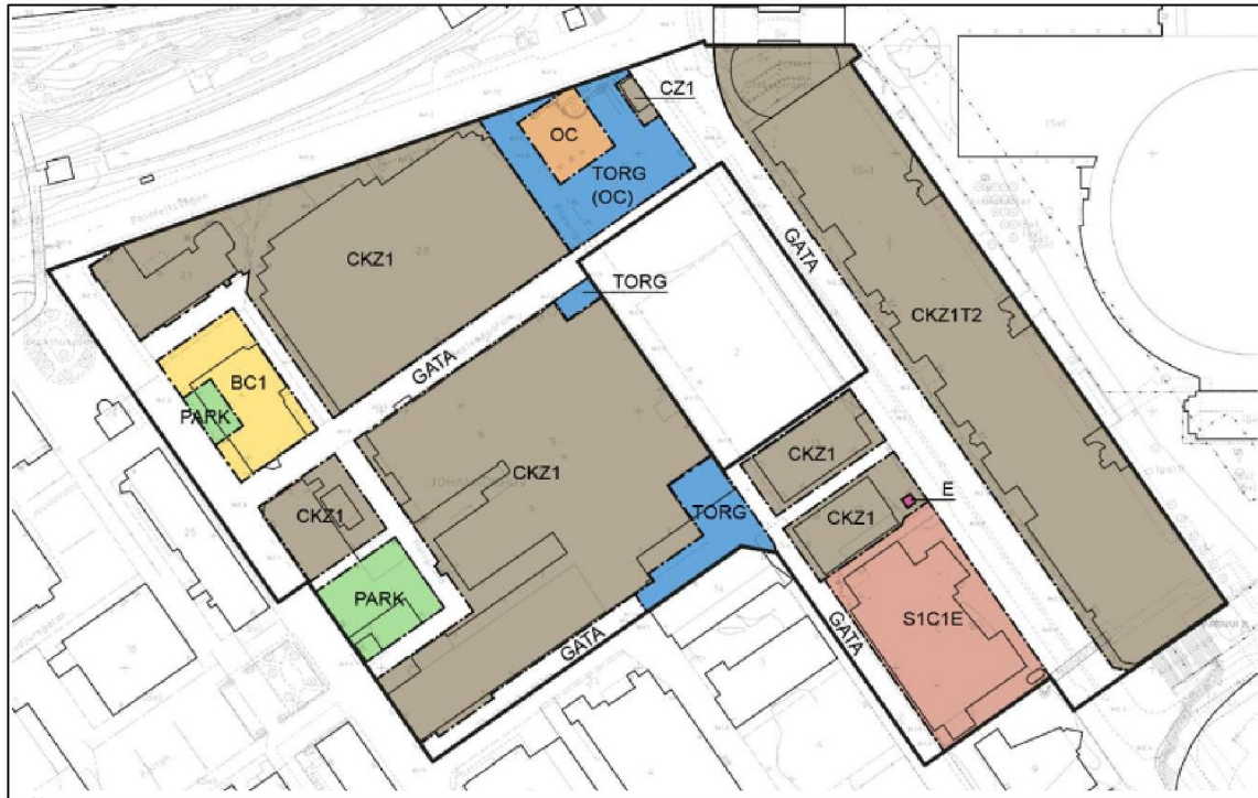
Figur 2-4. Övergripande markanvändning. Bruna ytor används för centrum, kontor och verksamheter med liten omgivningspåverkan. Gul yta är bostäder, orange yta är hotell, röd yta är skola, blå yta är torg och grön yta är park. Utrymme för tunnelbana (T) ges inom Globen shopping (Arenan 2).
