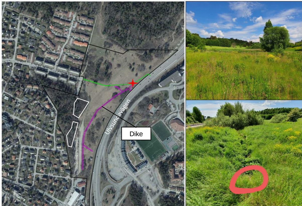
Figur 16. Ortofoto över planområdet (svart), utredningsområdet i vitt, befintligt dike (lila) och dagvattenledning (grön) samt bilder tagna i planområdet under platsbesök 2021-06-10. Nere till höger visas övergången från dike till kulvert som sker ungefär i den röda stjärnan i vänstra bilden (WSP, 2021).
