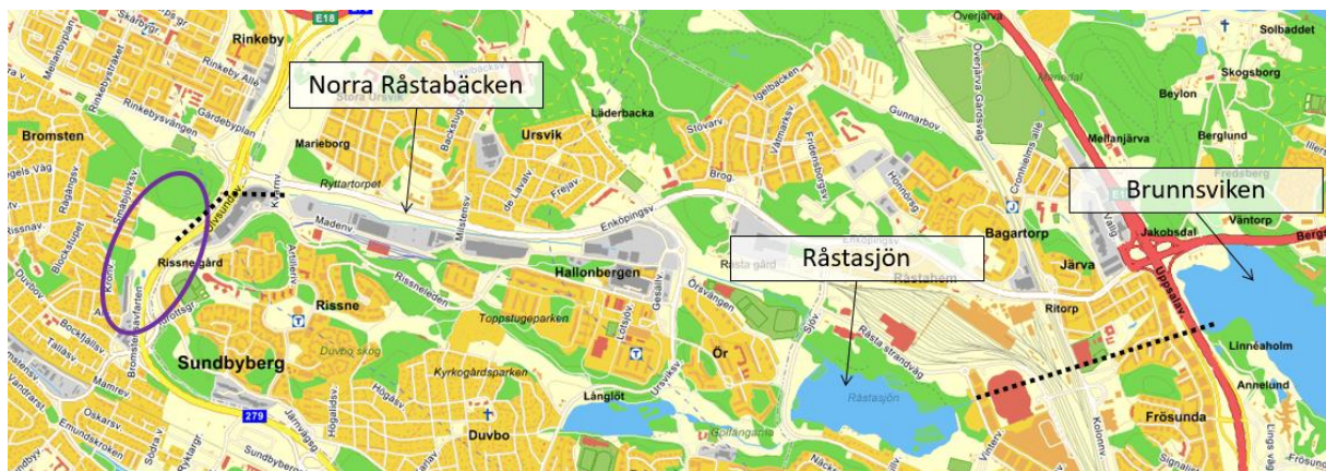
Figur 17. Översiktsbild av planområdet (lila inringning) och vidare avledning av dagvatten från planområdet. Prickad svart linje avser kuperterad eller delvis kuperterad del av vattendrag (WSP, 2021).
