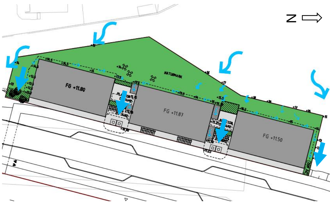
Figur 26. Planerad markanvändning och ytliga flödesvägar (markerade i blått) för norra kvarteret (Outer Space arkitekter, 2022).
