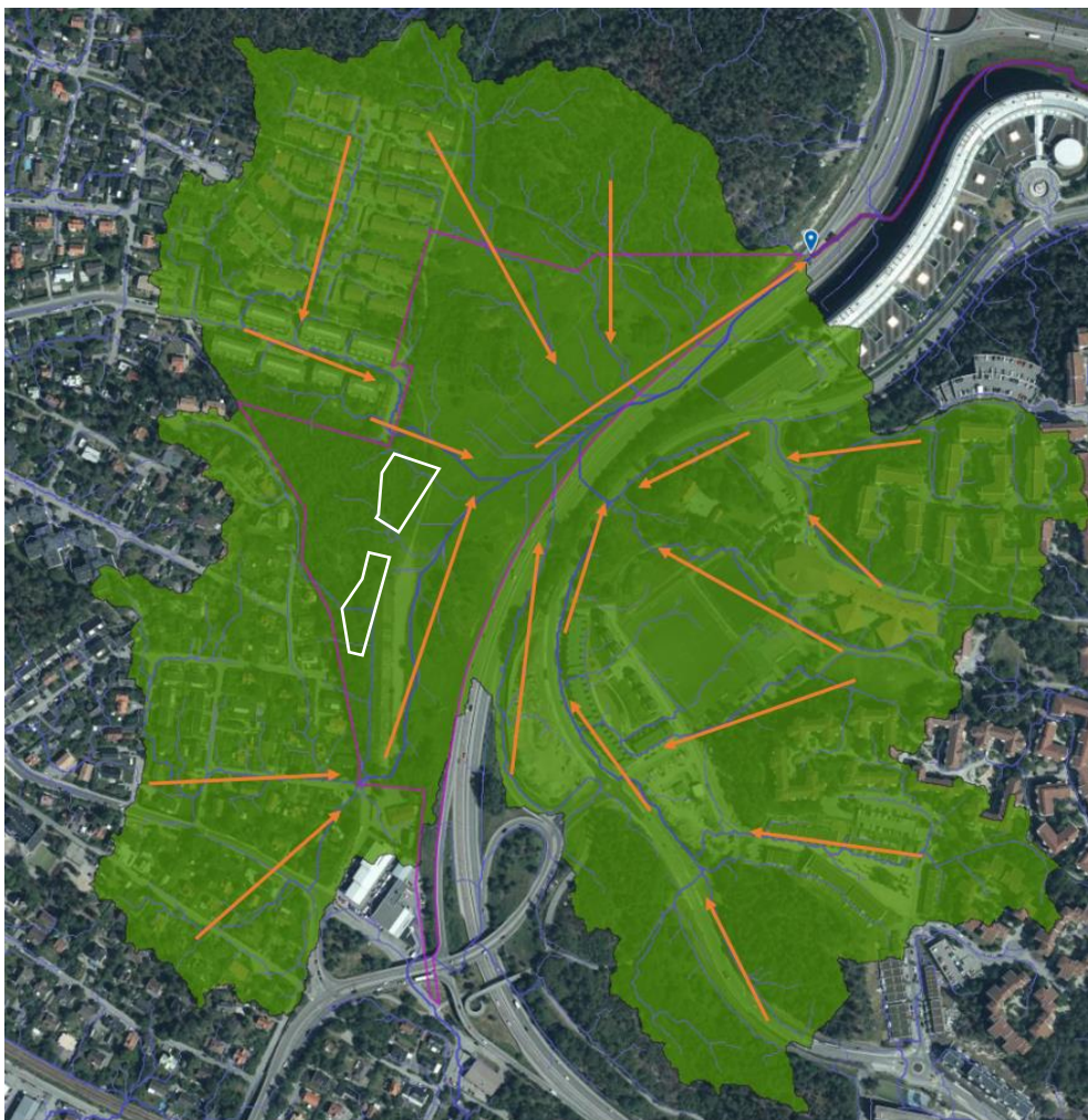
Figur 14. Planområdets avrinningsområde (grönt) samt flödesvägar (blått) och flödesriktningar (orange). Planområde markerat i lila och utredningsområdet i vitt (WSP, 2021).
