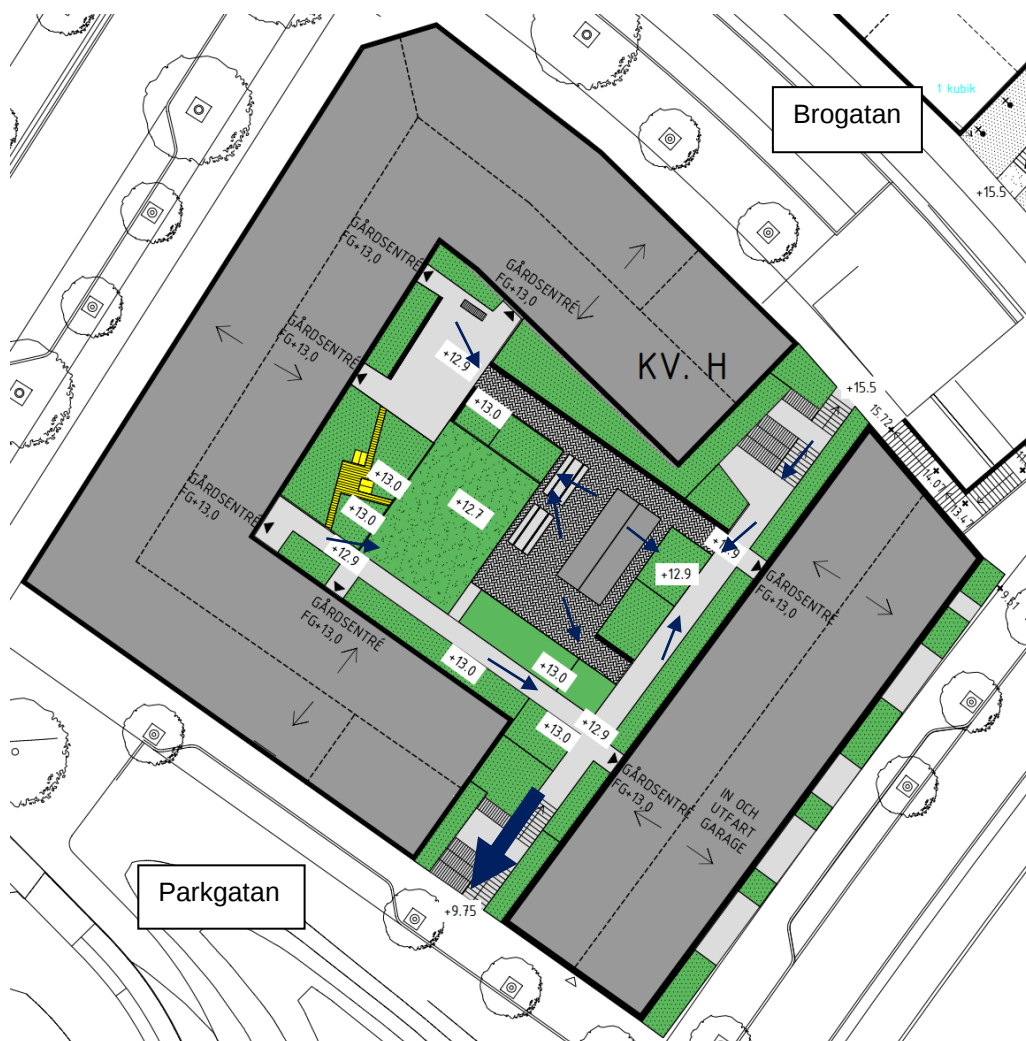
Figur A 8. Planerad markanvändning och ytliga flödesvägar (markerade i blått) för kvarter H (White, 2022c). De mindre pilarna visar avledning vid mindre regn till föreslagna dagvattenåtgärder. Fet, blå pil markerar möjlig brädning vid skyfall.
