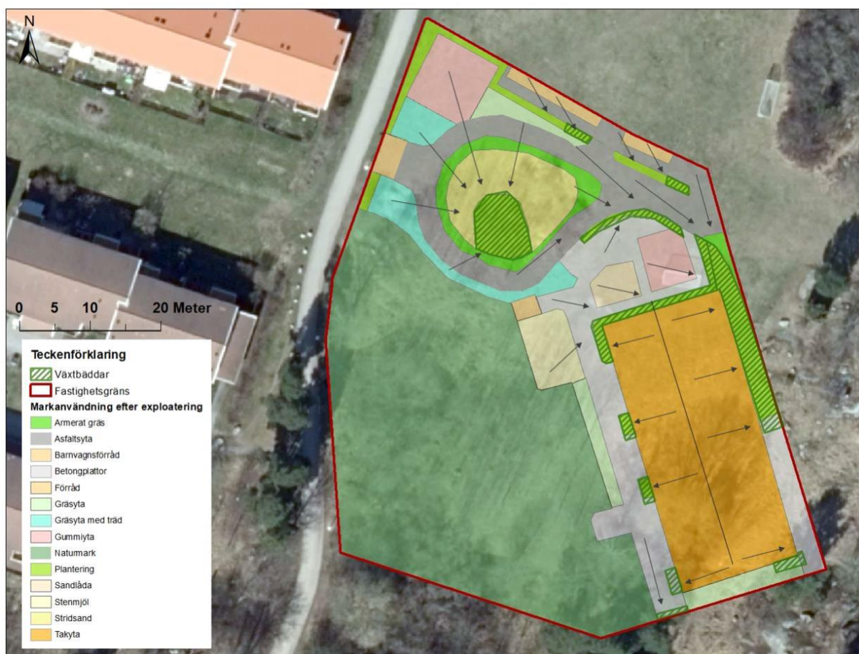
Figur A 10. Översikt av dagvattenhanteringen. Placering av växtbäddar utgår från skisser från landskapsarkitekt. (Afry, 2022)
