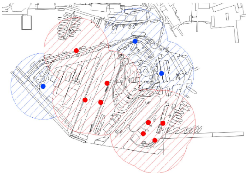
Illustrationen redovisar befintliga brandposter (blå) samt förslag på placering av nya brandposter (röd). Skraffering visar 75 meters avstånd från brandpost. Källa: Sweco
