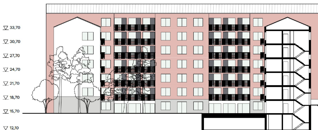
Figur 3. Sektion genom kvarter E som visar lägsta golvnivåer. Skiss tillhandahållen från arkitekt per mejl 2022-04-06.
