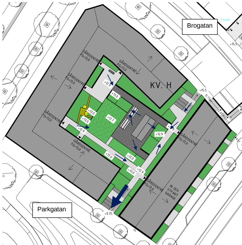
Figur 26. Planerad markanvändning och ytliga flödesvägar (markerade i blått) för kvarter H (White, 2022c). De mindre pilarna visar avledning vid mindre regn till föreslagna dagvattenåtgärder. Fet, blå pil markerar möjlig bräddning vid skyfall.
