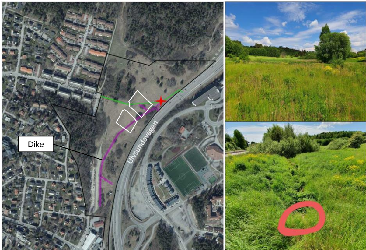
Figur 14. Ortofoto över planområdet (svart), utredningsområdet i vitt, befintligt dike (lila) och dagvattenledning (grön) samt bilder tagna i planområdet under platsbesök 2021-06-10. Nere till höger visas övergången från dike till kulvert som sker ungefär i den röda stjärnan i vänstra bilden (WSP, 2021).
