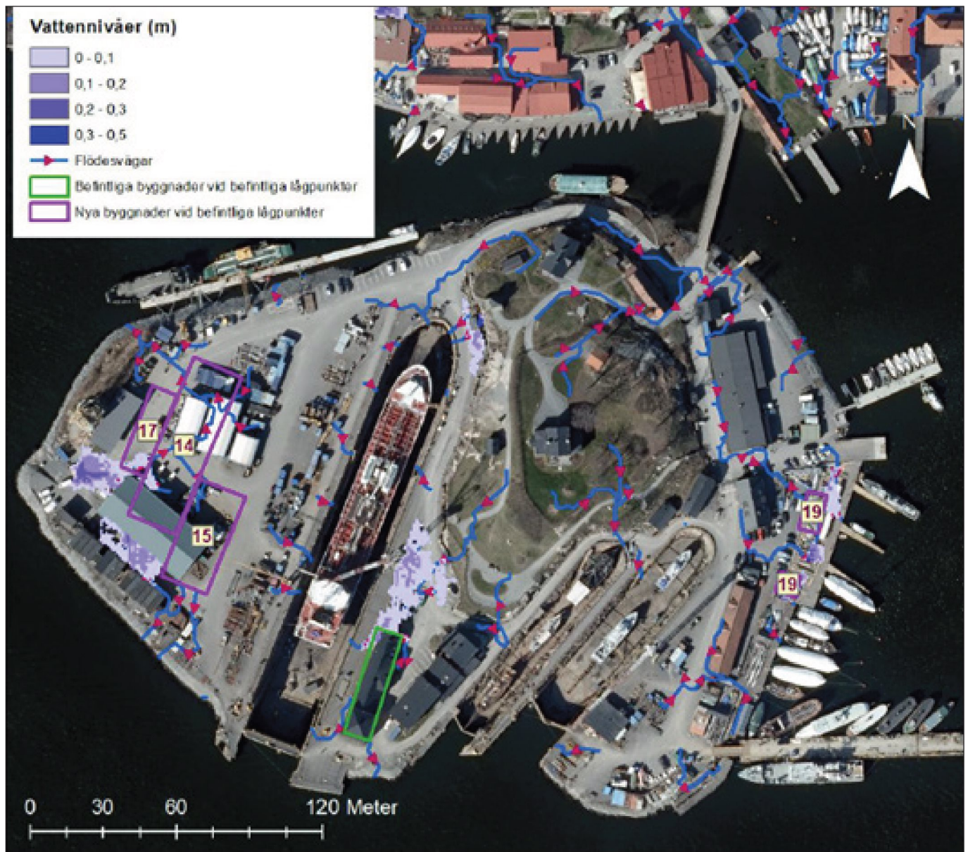
Figur 6-18 – Vattendjup i lokala lågpunkter och flödesvägar vid kraftig nederbörd (68 mm, motsvarande ett 100-årsregn med 60 minuters varaktighet och klimatfaktor 25 %). Befintliga och planerade byggnader som ligger i lågpunkter visas i figuren. Bakgrund: Ortofoto från Lantmäteriets visningstjänst
