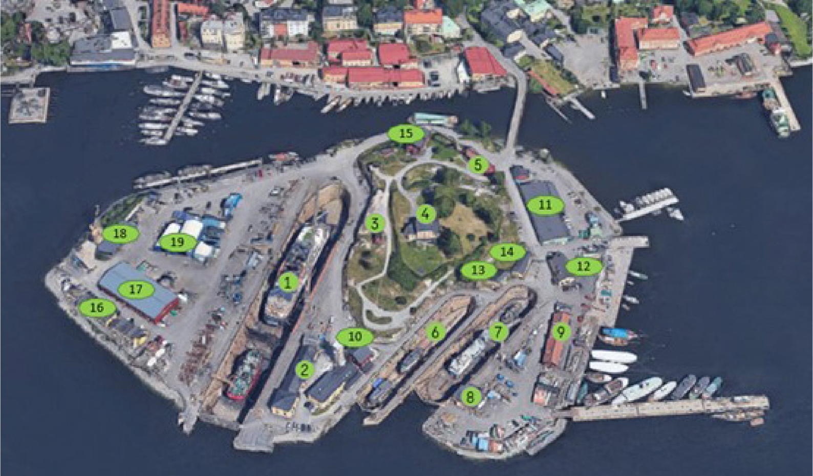
Figur 2-2. Översiktsbild över Beckholmen. 1: Gustav V:s docka, 2: Pumphus GV, 3: Tullpaviljongen, 4: Stenvillan, 5: Gamla Tjärmästarbostaden, 6: Västra dockan, 7: Östra dockan, 8: Gamla Pumpverket, 9: Stöttboden, 10: Bostadshus 502, 11: Vasakonserveringen, 12: Radarskolan, 13: Smedjan, 14: Klockhuset, 15: Hus 505, 16: Personalbodarna, 17: Verksadshall och förråd, 18: Miljöstation, 19: Tält och containrar
