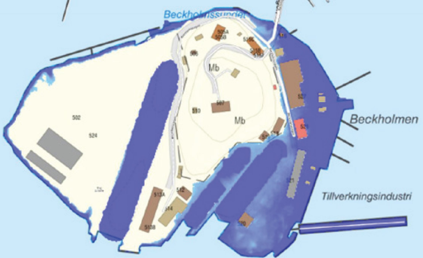
Figur 6-17. Landområden inom detaljplanen som ligger under den rekommenderade lägsta grundläggningsnivå på 2,7 meter enligt RH2000 markeras med blått
