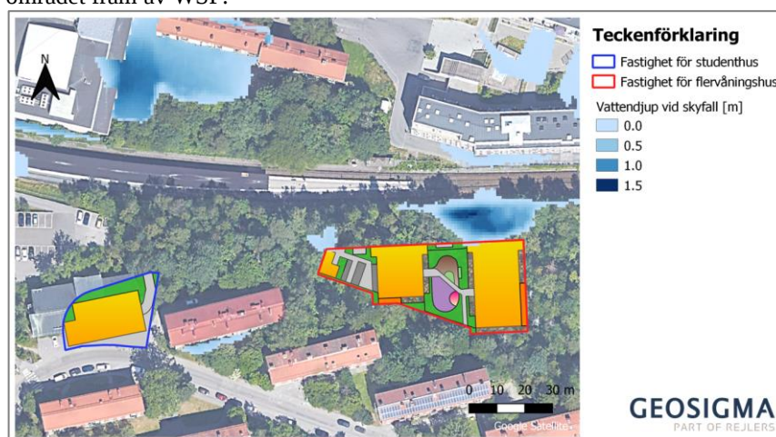
Figur 8-1. Översikt över översvämmade områden vid ett 100-årsregn samt vattendjup i meter.
