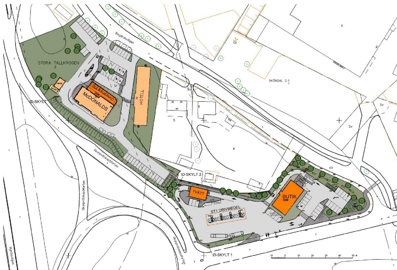
Situationsplan över föreslagen utbyggnad av befintlig snabbmatsrestaurang i norr, samt nybyggnad av drivmedelsstation i söder. Byggnader markerade i orange färg är nya byggnader och tillbyggnader. Byggnader markerade i orangegul färg utgör befintliga byggnader. (Arkitekt: Arkoo Arkitekter AB)
