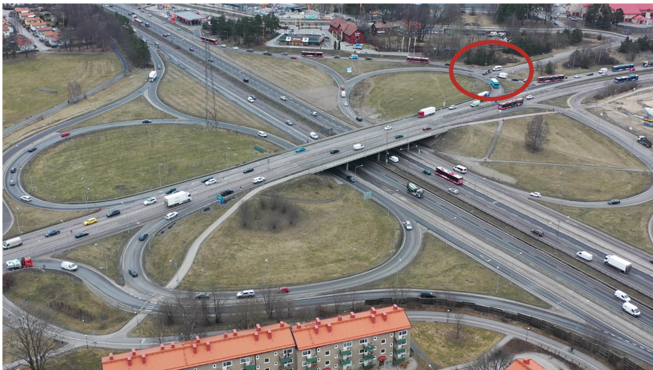
Exempel på situation från morgonrusningen där bilar från Vinthundsvägen släpps in av trafiken på ramperna (på detta foto, främst av trafik från Tyresö). En vidare diskussion kring förarnas förväntade beteende under lågtrafik återfinns i rekommendationen i senare kapitel.
