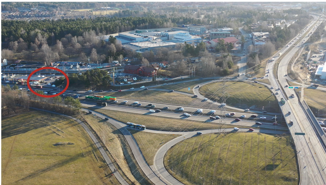
Exempel på situation från morgonrusningen där en viss (kortare) köbildning har uppstått på avfarten från rampen in mot Circle-K/lokalvägnätet. Denna kö leder in mot pumparna.
