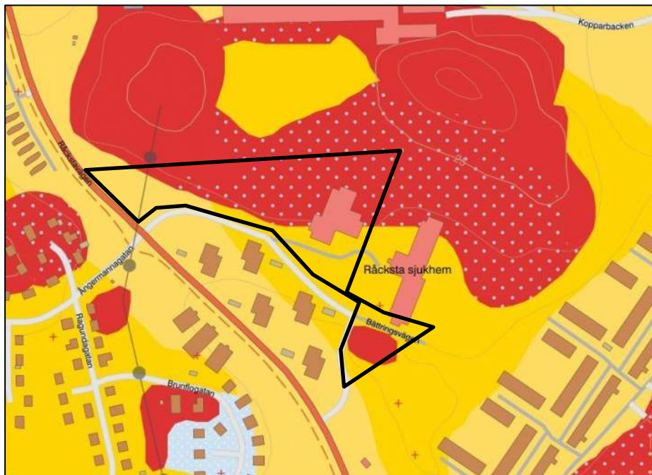
Figur 2-2. Jordartskarta hämtad från SGU:s karttjänst (2021) med berg (rött), berg täckt av morän (rött med vita prickar), glacial lera (mörkgult) och postglacial lera (ljusgult). Lokalisering av undersökningsområdet är inom svart markering.
