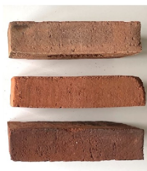
Fasad ska utföras i rött tegel med stor nyansvariation (terrakottarött med mörkare inslag) och slagen yta.
