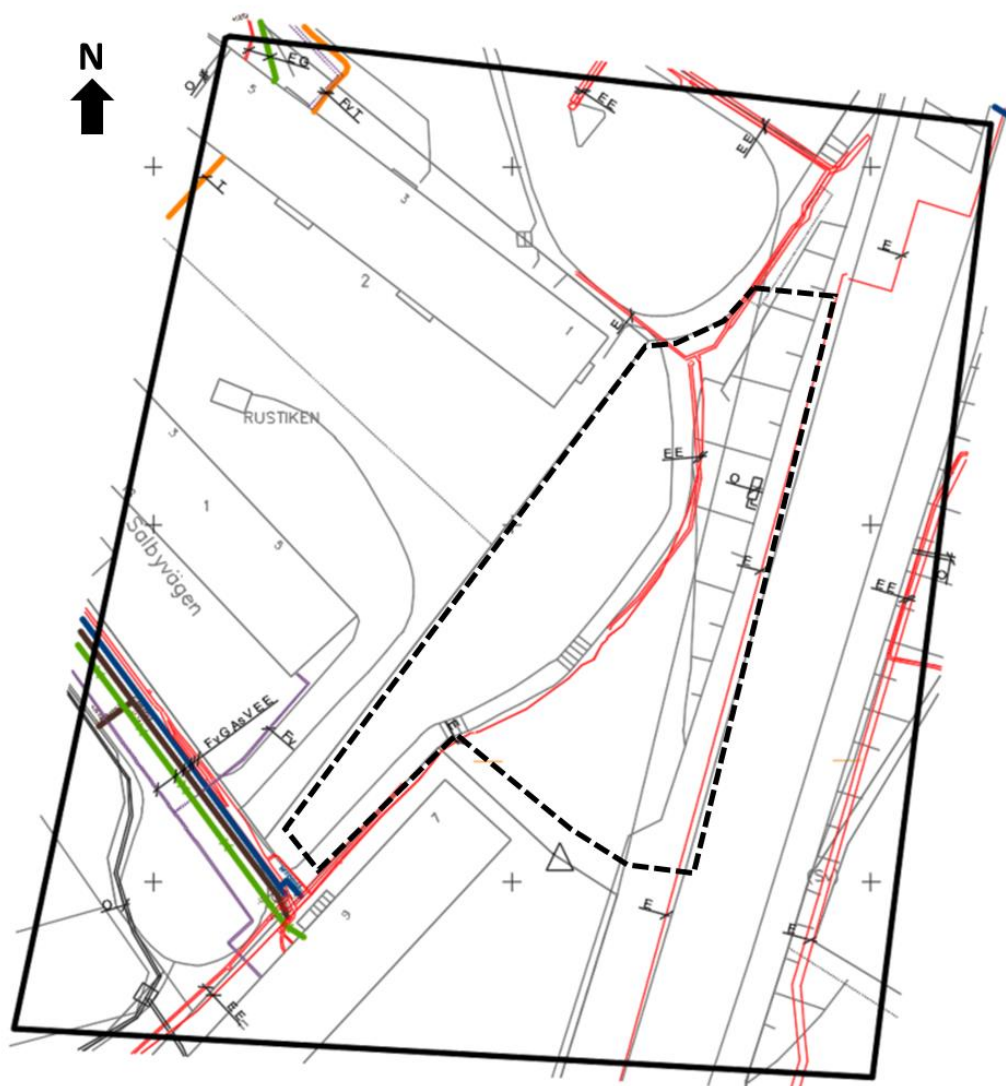
Figur 3-6. Urklipp från samlingskarta. Brun linje avser spillvattenledning. Någon dagvattenledning verkar inte finnas. Ungefärlig planområdesgräns markerad med svart streckad linje.
