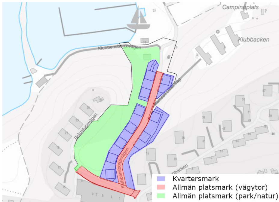
Figur 2. Kartöversikt. Den planerade exploateringen ligger inom svarta linjer. Uppdelning kvartersmark (blå yta) och allmän platsmark (röd yta). Även allmän platsmark för park/natur visas (grön yta).
