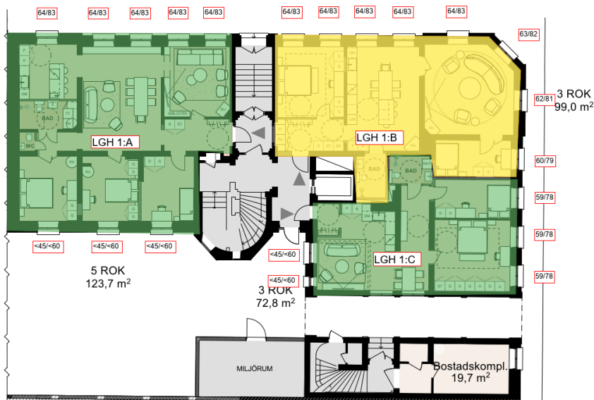
Figur 1. Planlösning för plan 1 med ljudnivåer från trafikbuller vid respektive fönster redovisade som ekvivalent ljudnivå i dBA/maximalljudnivå i dBA.
