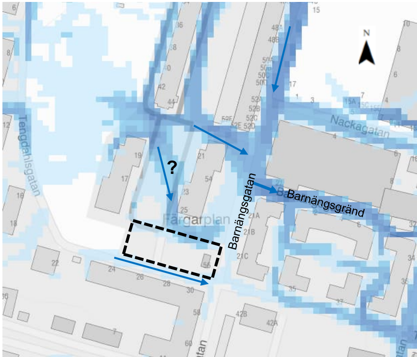
Figur 3. Stockholms stads skyfallskartering med markerade flödesvägar vid ett 100 års regn (hämtad 2021-09-20). Utredningsområdet markerat med svart streckad linje. Inlagd rinnpil med frågetecken markerar tveksam rinnriktning i stadens skyfallsmodell. Stadens flödesredovisning visar dock inte riktning vilket skulle kunna betyda att rinnriktningen är den motsatta i modellen.
