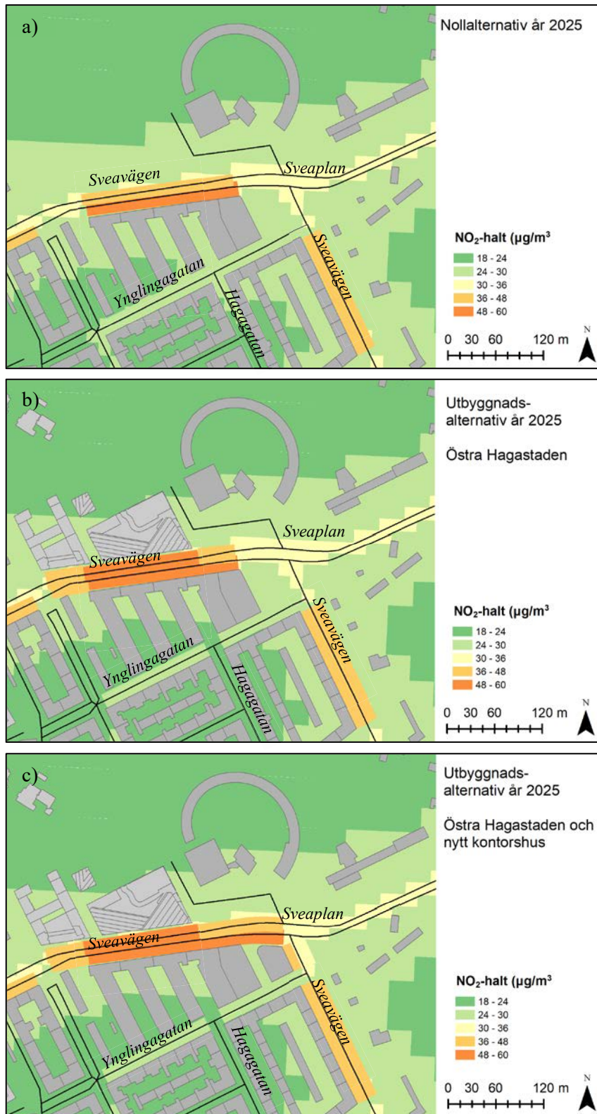
Figur 7. Beräknad dygnsmedelhalt av NO 2 det 8:e värsta dygnet år 2015 för (a) ett nollalternativ, (b) utbyggnadsalternativ 1 och (c) utbyggnadsalternativ 2.
