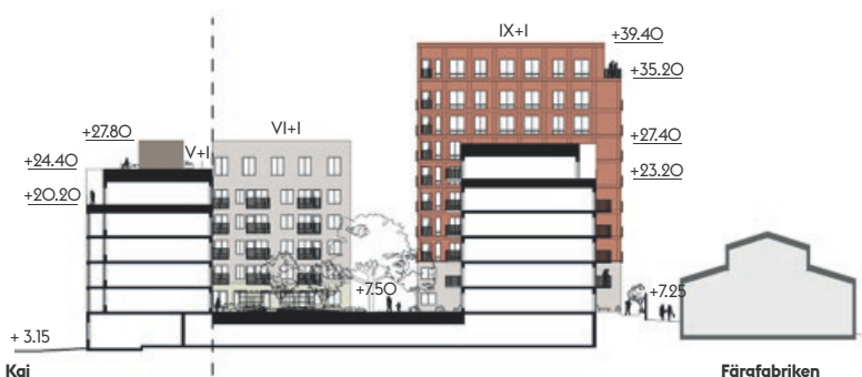
Sektion genom kvarteret – redovisar gaturummet mot färgfabriken samt kvarterets innergård och släpp vid den högre byggnadsvolymen (skala 1:1000).
