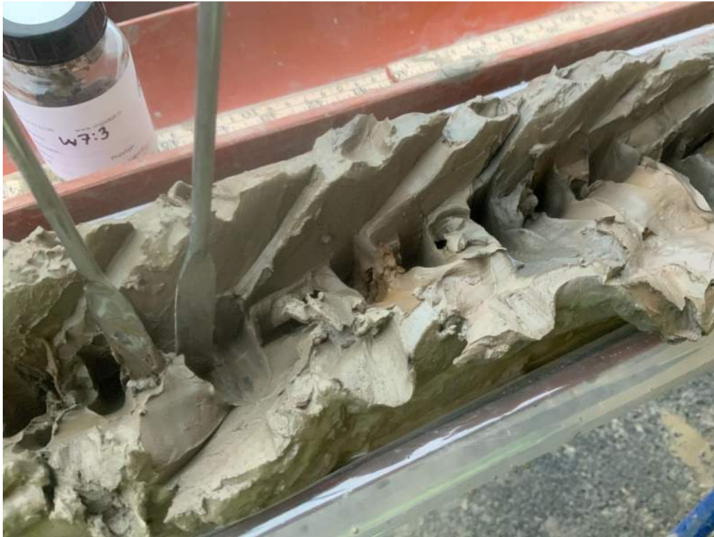
Figur 2-1 Exempel på provtagning, prov W7:3. Bilden visar en uppbruten kärna och hål efter de provuttag som genomförts och placerats i redcap-vialen.
