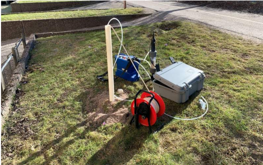
Figur 3-1 Provtagning av grundvatten med peristaltisk pump kopplad till flödescell och multimeter.
