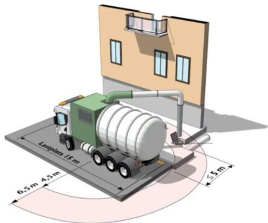
Figur 4. Angöringsyta för mobil sopsug (Stockholm vatten och avfall - Projektera och bygg för god avfallshantering, 2018).
