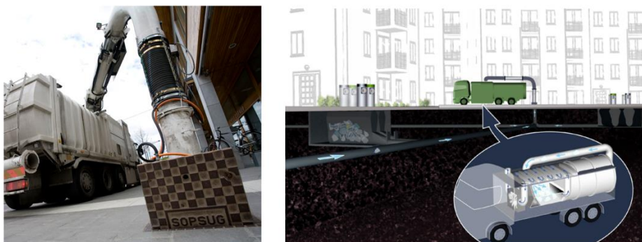
Figur 3. Tömning med mobil sopsug (Avfall Sverige), och illustration för insamlingsystemet (Envac).
