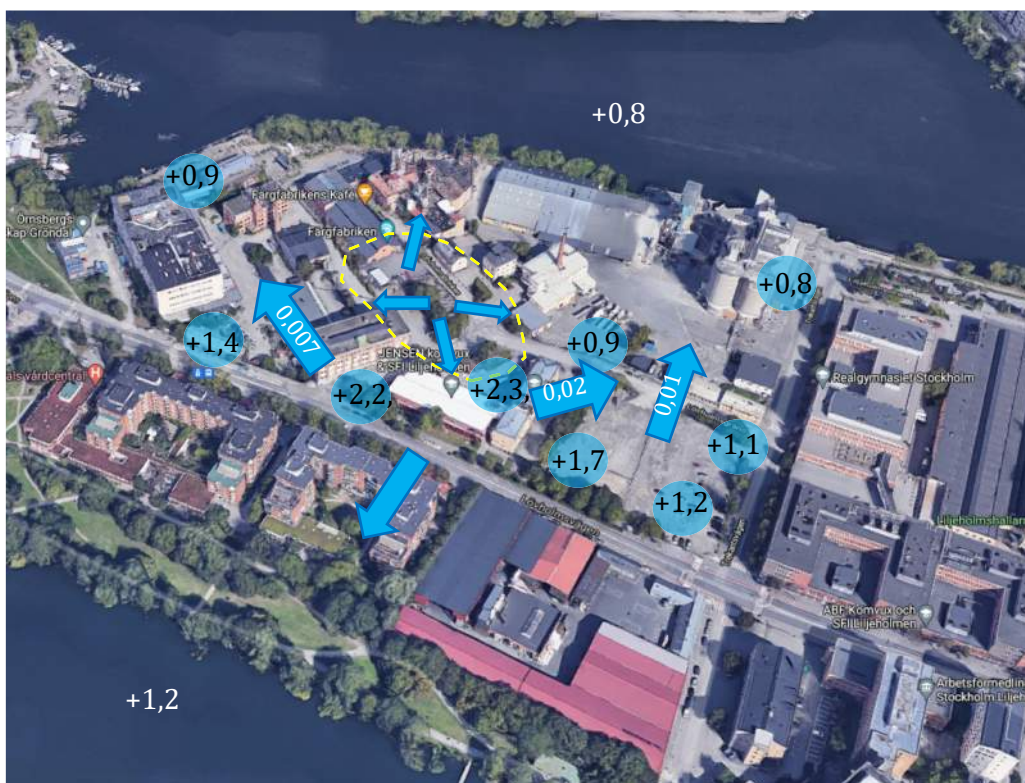
Figur 4-6 Grundvattennivåer samt bedömd strömningsriktning. +höjder visar vattennivåer, gul streckad linje visar det ytliga berget och stora blå pila är bedömd strömningsriktning samt gradient i m/m hos grundvatten. Små pilar visar avrinning från bergytor.
