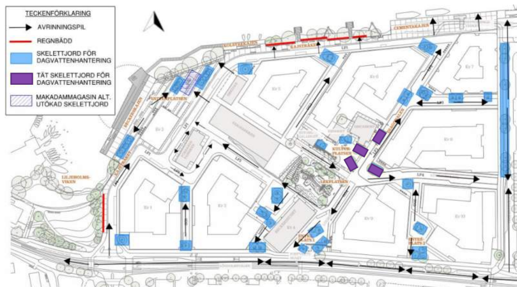
Figur 11- Skiss av omhändertagande av dagvatten inom planområdet, bild från Dagvattenutredning, Structor 2023.
