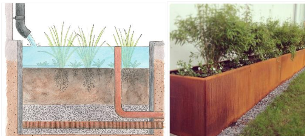
Figur 17. Principsektion utförande av växtbädd/dagvattenplantering.
