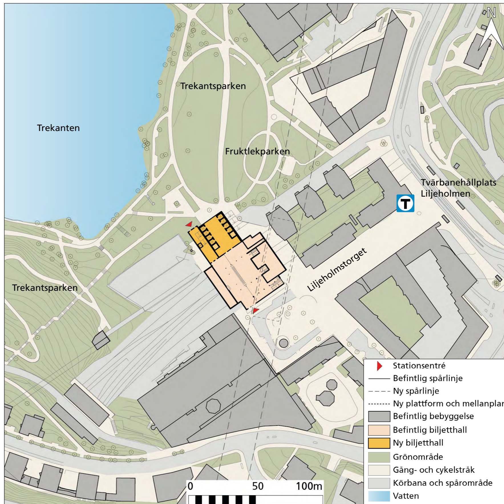
42: Biljetthallen i Liljeholmen byggs ut mot parken för att skapa utrymme till högkapacitetshissarna och åtkomst till den nya linjen norrifrån.
