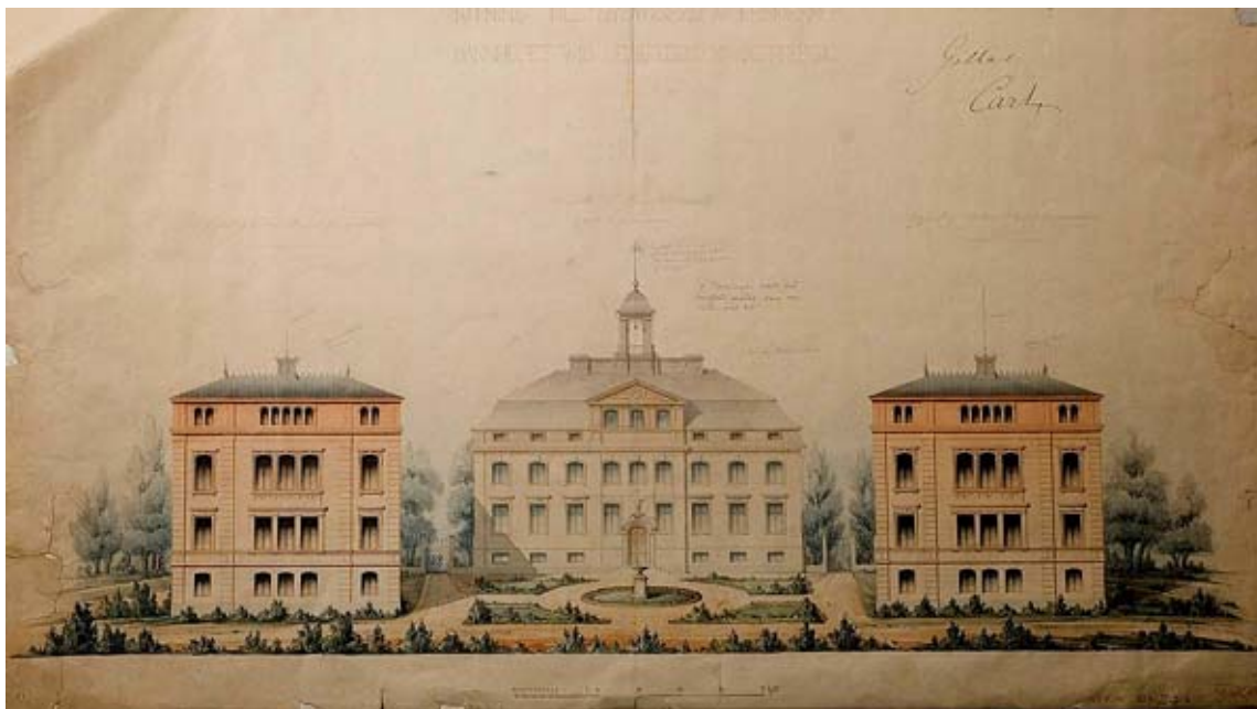
Ritning till nybyggnad av Frimurarebarnhuset vid dess egendom Kristineberg, signerad Johan Fredrik Åbom. Ritningen är utan datering, men torde vara utförd 1864 eller 1865. Huvudbyggnadens fasad mot norr utfördes inte helt enligt ritningen, takfoten höjdes aldrig och den översta låga fönsterraden insattes inte. Dessutom utfördes attikan med ett mindre bågmotiv istället för gavelmotivet. NS 9:15, Frimurarebarnhusdirektionen, SSA. Foto Göran Fredriksson, SSM.
