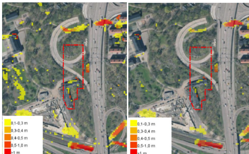
Simulering av maxdjup vid ett 100-årsregn och klimatfaktor 1,25.
