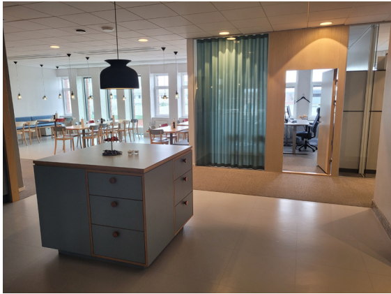
Pausrum mot söder på 2 tr, där fönsterbröstningarna har rivits ned till golvnivå i tre fönsternischer..
