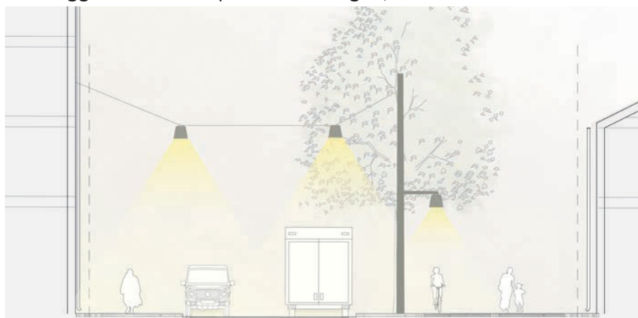
Linspänn fasad till stolpe 8m, med/utan armatur mot GC 4m. Exempel från Hallvägen, sektion 1:200
