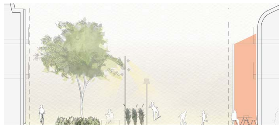
Parkstolpe 4m samt strålkastarstolpe 6m. Exempel från Högrevgatan, sektion 1:200
