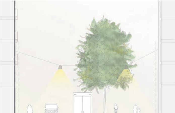
Exempel Hallvägen, linspänn fasad-fasad, sektion 1:200
